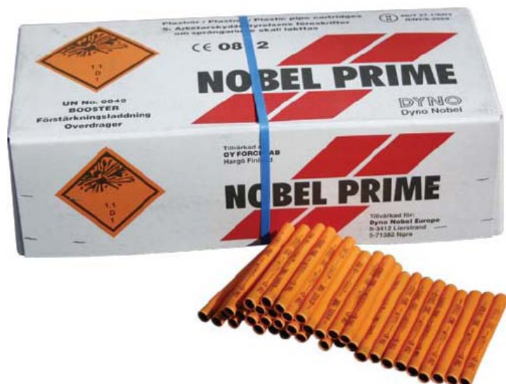
Figur 24 15X150 mm primer for tenning av SSE bunnladning. Denne legges i slange-åpningen før ladeslangen føres til bunns.
