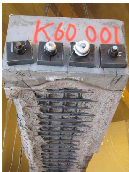
Slik ser et betongelement uten pp-fiber ut etter en HC-brann
