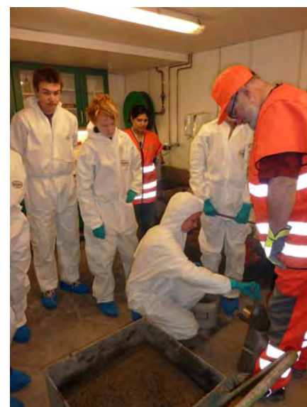
Måling av slump på egenprodusert betong
