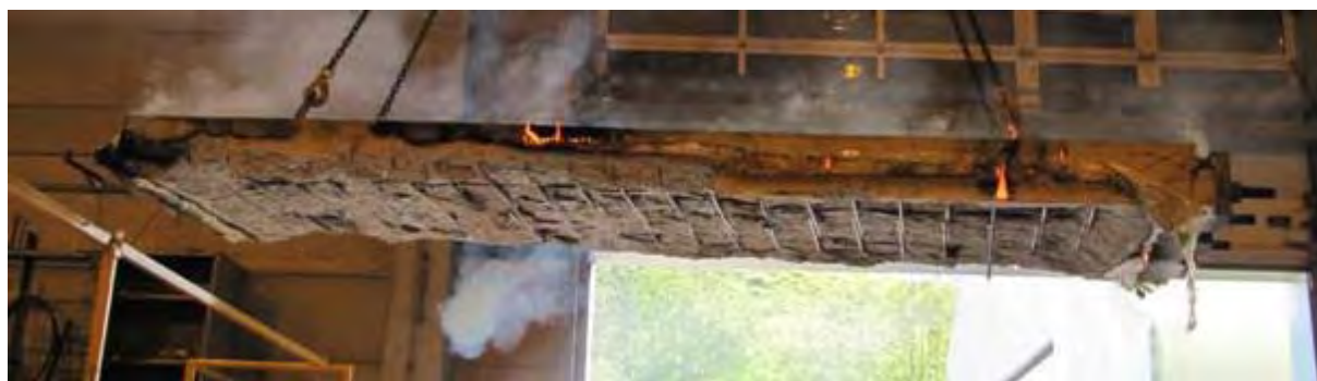
Figur 9 Betongelement uten PP-fiber etter branntesting
