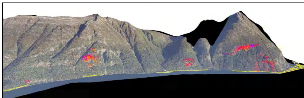
Figur 18 Dekning av RADAR-målingene langs Oppdølsstranda vist i 3D. Legg merke til at dekingen er best i de loddrette og vegetasjonsfrie skrentene i fjellsiden, områder som også antas å være de mest aktive for steinskred.
