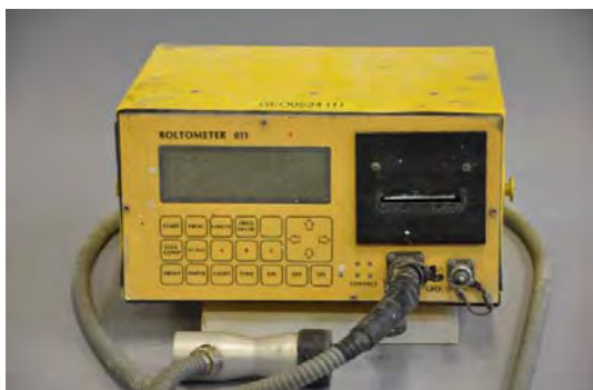
Figur 16 Bilde av gammelt boltometer som skal erstattes med nytt utstyr.
