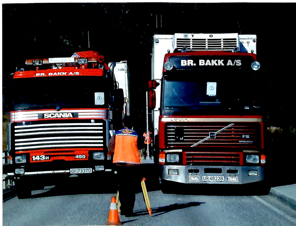
Over: Lastoppstilling over senter på midtspennet.
