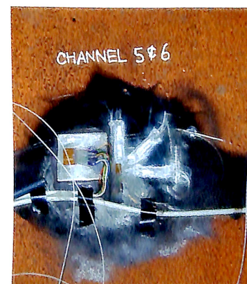
Under: Optiske fibre limt på innsiden av stålkasse.
