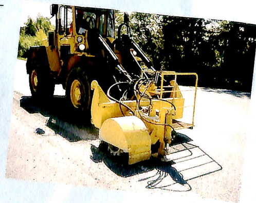
Den nye vegmerkingsfresen med sjåfør Sindre Hjelset.
