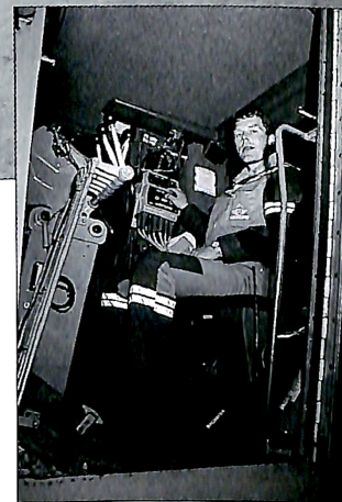
førerhuset kan han styre avrettinga med nesten millimeters nøyaktighet, forteller Arnstein Bolli.
