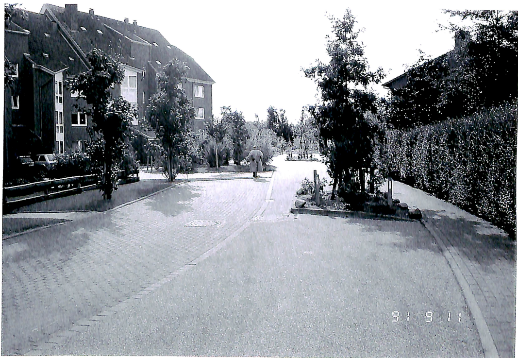
Innsnevring med vekslende sidehindre virker utvilsomt fartsdempende, men ødelegger gaterommet og gir et rotete inntrykk.
