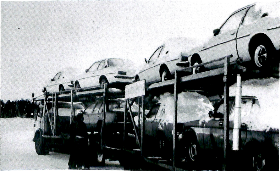
Inspektør Rømme påpeker manglende sikring av den øverste bilrekken.
