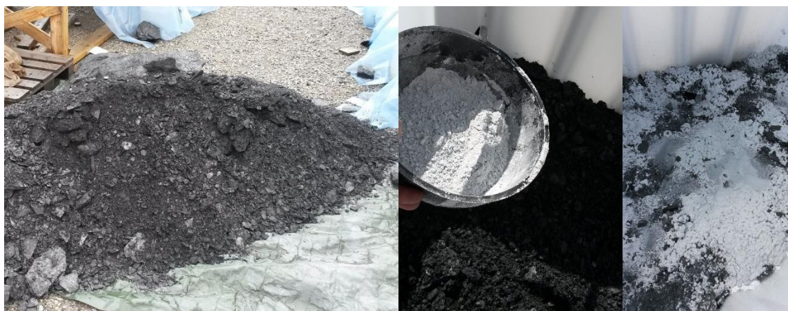
Figur 4. Bildet til venstre viser alunskifermassene som ble brukt i forsøk 2. Massene ble hentet fra tunnelen og deretter fylt over i 4 konteinere, med 200 L i hver. To av konteinerne fikk også tilført kalksteinmel, som illustrert i de to bildene til høyre.
