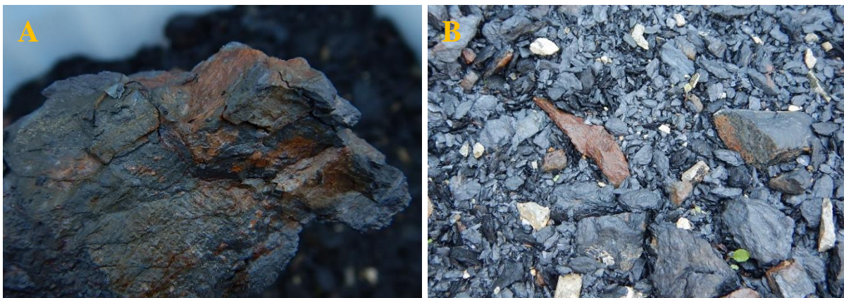
Figur 47. A. Galgebergskifer etter 1 år i friluft. B) Ulik grad av rustfarge på galgebergskiferen i konteineren. De hvite steinene er innslag av bergarten mænaitt
