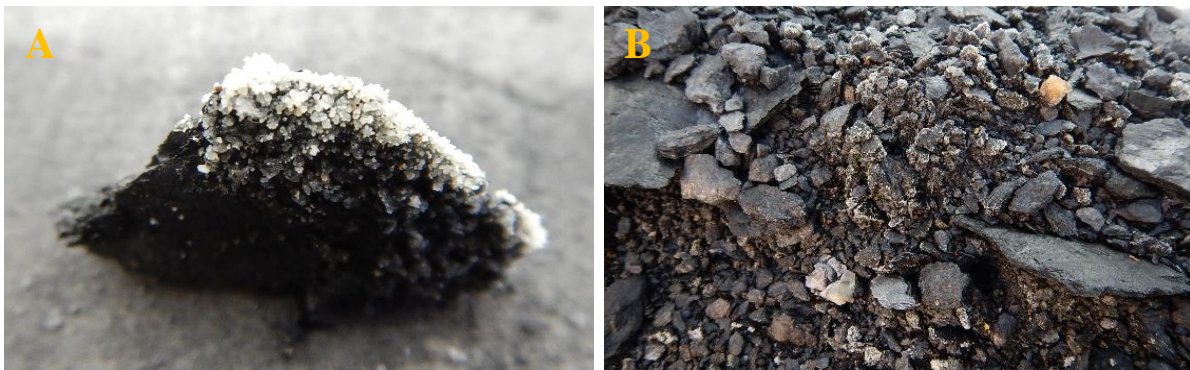
Figur 46 A og B. Gipsutfellinger på skifer i konteiner 8 (A3) 30.09.2015. Gips ble også sett i konteinerne A2K, AT2 og AT4K. Alle disse konteinerne inneholdt alunskifer.
