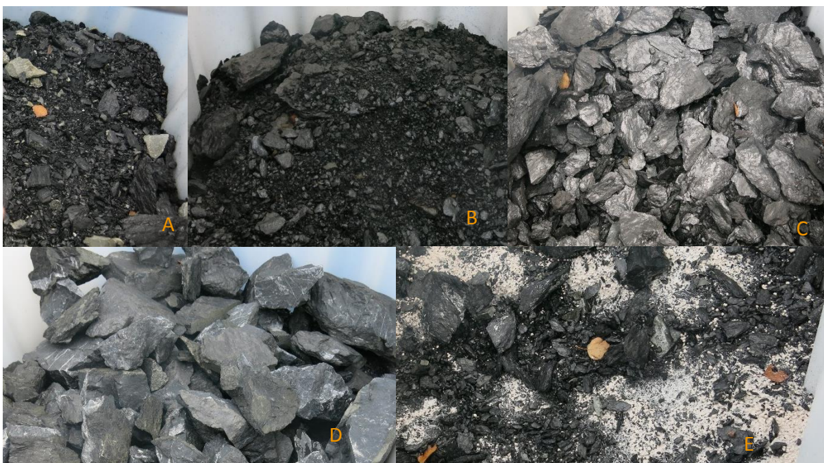
Figur 3. Massene som ble brukt i forsøk 1. Bildene er tatt i ulike forsøkskonteinere etter to ukers eksponering. A) Svartskifer fra galgeberg-formasjonen, hentet fra tunnelen (G2). B) Alunskifer hentet fra skjæring (A3). C) Alunskifer med mindre fragmenteringsgrad hentet fra skjæring, (A1). D) Kalkstein (huk-formasjonen) hentet fra tunnelen. Kalksteinen er strødd over galgeberg svartskifer (G4H). E) Svartskifer fra galgeberg-formasjonen med dolomittisk kalk strødd over (G5H).
