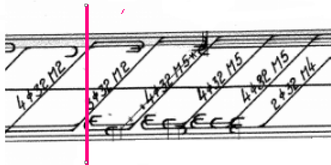
Figur 9.9: Momentnullpunkt 4 m fra støtte
