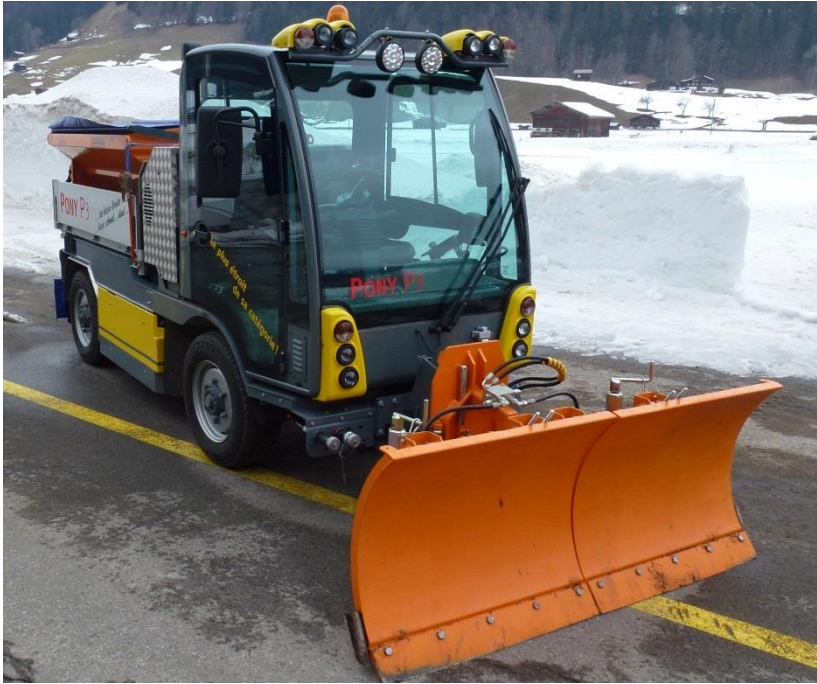
Figur 4-53 Eksempel på plog egnet for arbeid på fortau og gang- og sykkelveger (Foto: Dagfin Gryteselv, Statens vegvesen)
