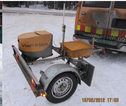
Figur 5-18 ViaFriction-friksjonsmåler, hengerversjon (Foto: Dagfin Gryteselv, Statens vegvesen)
