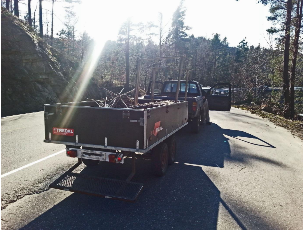
Figur 2-86 Kjøretøyet er ikke utstyrt med gult blinkende lys. Henger er påmontert en plattform, der operatøren står mens kjøretøyet er i fart. (Foto: Dag Øystein Løyning)
