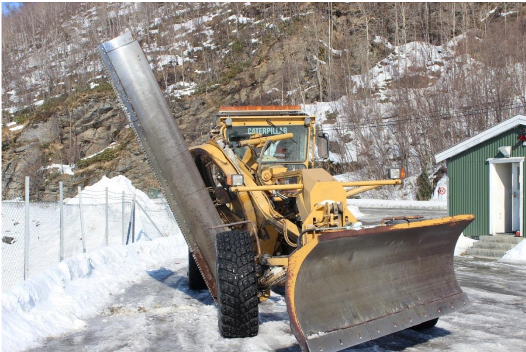
Figur 4.75 Høvel for nedtaking av snøkanter (Foto: Odd Dalmo, Statens vegvesen)
