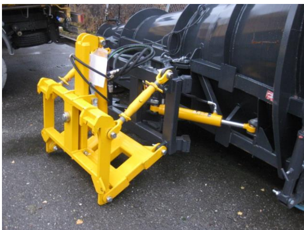
Figur 4-26 Diagonalplog med hydraulisk skråstilling (Foto: GMI)
