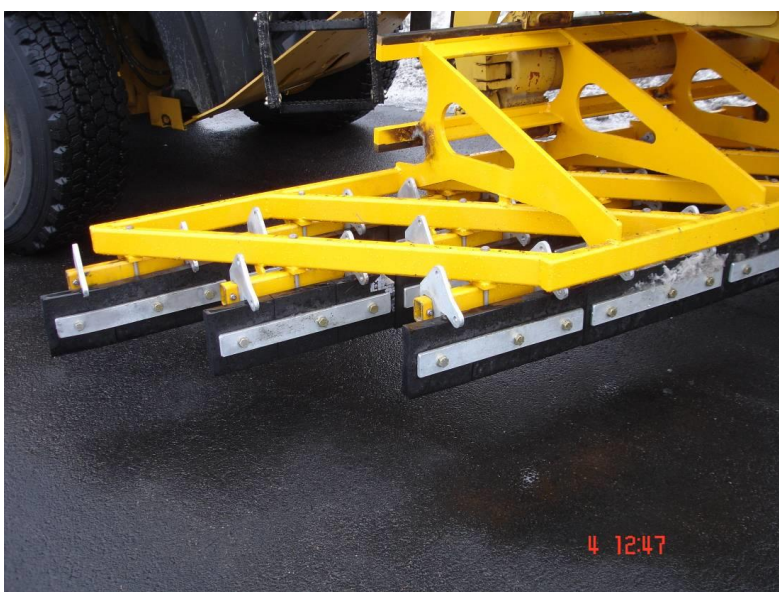
Figur 4-46 Slapsegrind montert på høvel (Foto: Torgeir Vaa)
