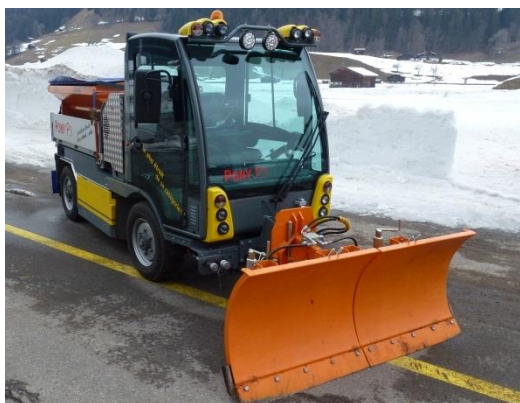
Figur 6-10 Eksempel på utstyr for gang- og sykkelveier med tallerkenspreder (sand/salt) og frontplog (Foto: Dagfin Gryteselv, Statens vegvesen)
