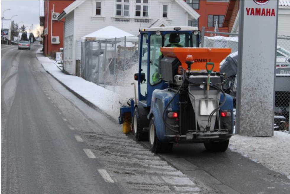
Figur 6-12 Eksempel på kjøretøy som benyttes på gang-sykkelveger i Stavanger-området (pass på sprut fra brøyteutstyr) (Foto: Eivind Stangeland, Statens vegvesen)
