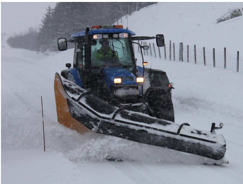
Figur 4-19 Traktor med diagonalplog (Foto: RISA AS)
