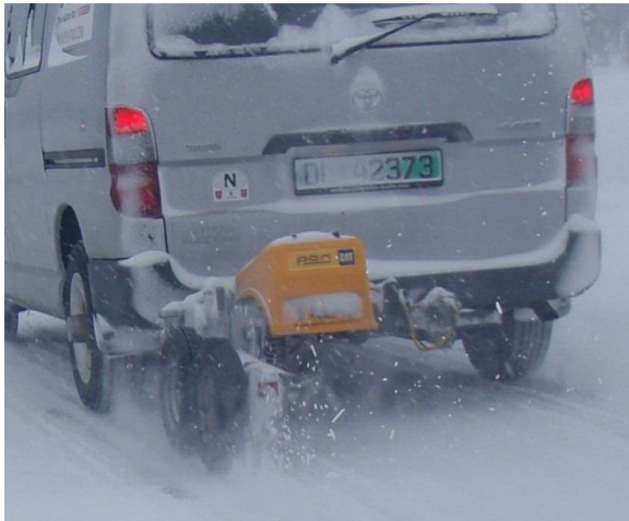
Figur 5-15 TWO-friksjonsmåler, rammemontert (Foto: Bård Nonstad, Statens vegvesen)
