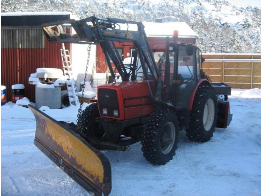
Figur 2-68 Lesseapparatet brukes til å heve og senke brøyteskjæret. Dette skaper ekstra blindsoner. (Foto: Jahn Ivar Systad)
