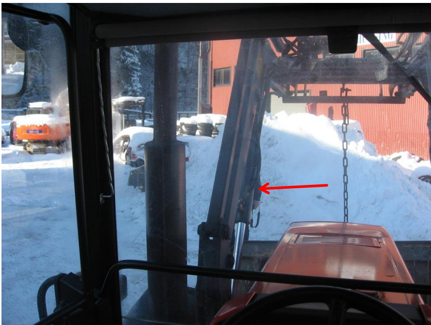
Figur 2-69 Her står det en person som er skjult av armen på lesseapparatet (Foto: Jahn Ivar Systad)
