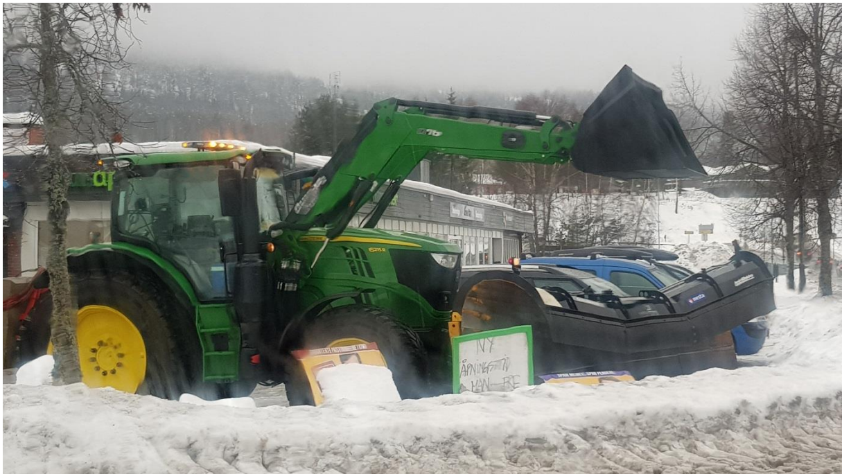
Figur 2-70: Traktor med både plog og frontlaster med påmontert skuffe. I tillegg til frontlaster og eksosrør tar også skuffa betydelig sikt.
