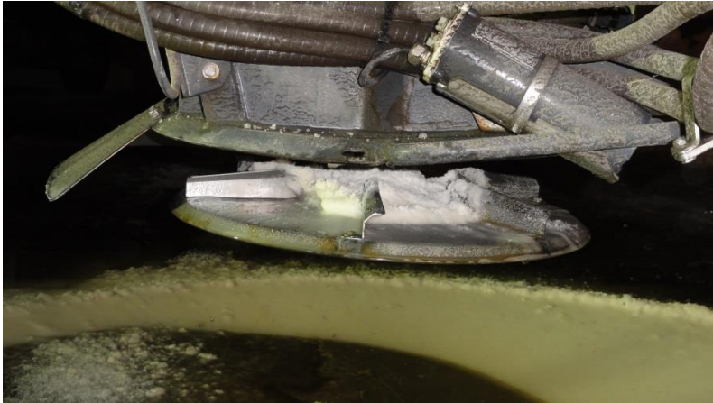
Figur 6-35 Strøttallerken må også sjekkes og rengjøres
