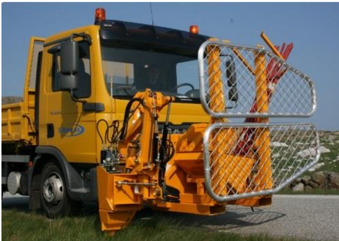
Figur 9-40 Utstyr for oppsetting av brøytestikk montert på lastebil (Foto: S. Risa AS)
