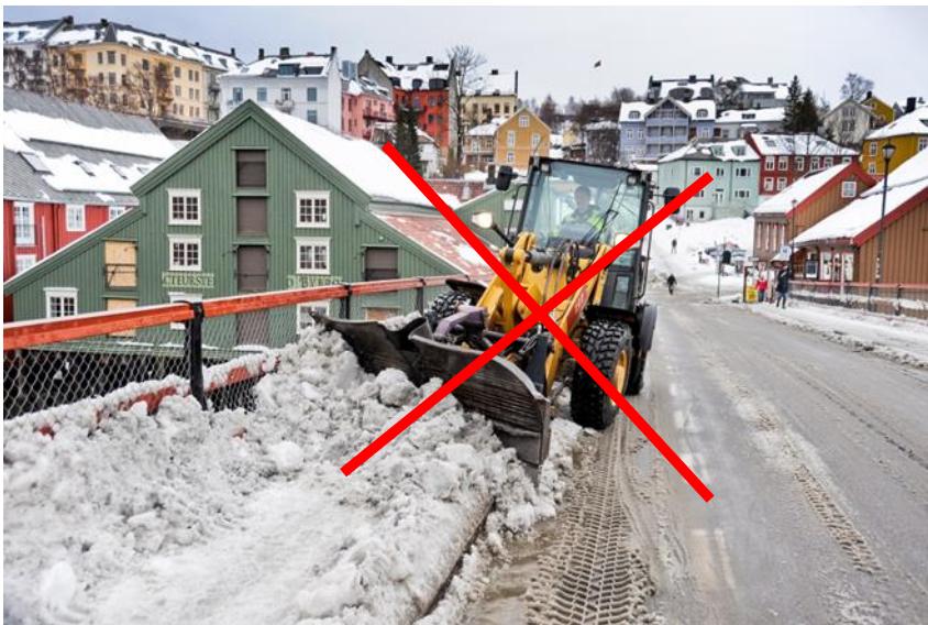
Figur 4-54 Eksempel på kjøretøy som er dårlig egnet til jobben som skal utføres (for tungt og bredt for brøyting på fortau) (Foto: Knut Opeide, Statens vegvesen)
