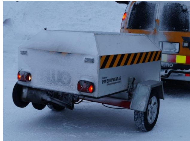
Figur 5-16 TWO-friksjonsmåler, hengerversjon (Foto: Bård Nonstad, Statens vegvesen)
