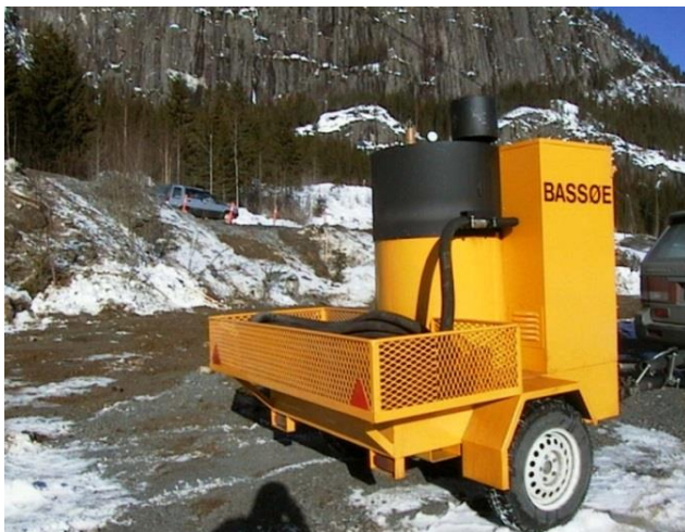
Figur 9-31 Bassøe tineutstyr med tilhengerunderstell (Foto: Glomsrød Mek. Verksted)
