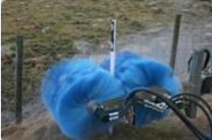
Figur 9-37 Utstyr for vasking av kantstolper (Foto: S. Risa AS)
