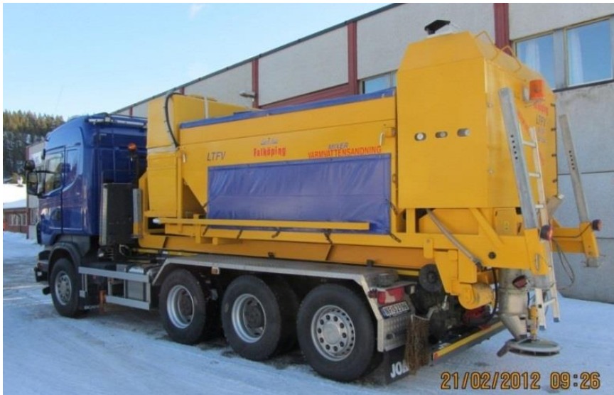
Figur 6-4 Fastsandspreder kan også brukes som saltspreder for befukting med varmt eller kaldt vann (Foto: Dagfin Gryteselv)
