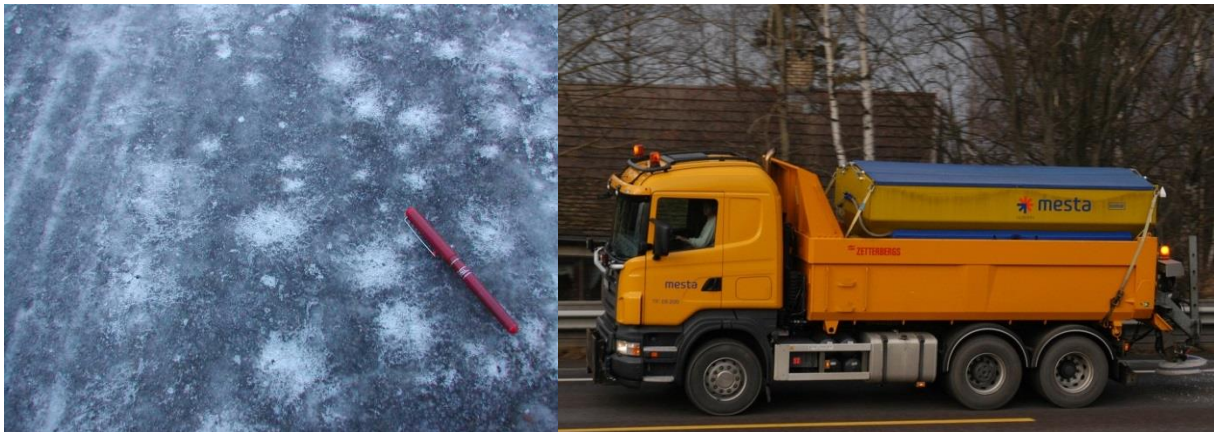
Figur 8-4 De-ising – Salting for å fjerne et is- eller snødekke (Foto: t.v. Torgeir Vaa, t.h. Håkon Aurlien)
