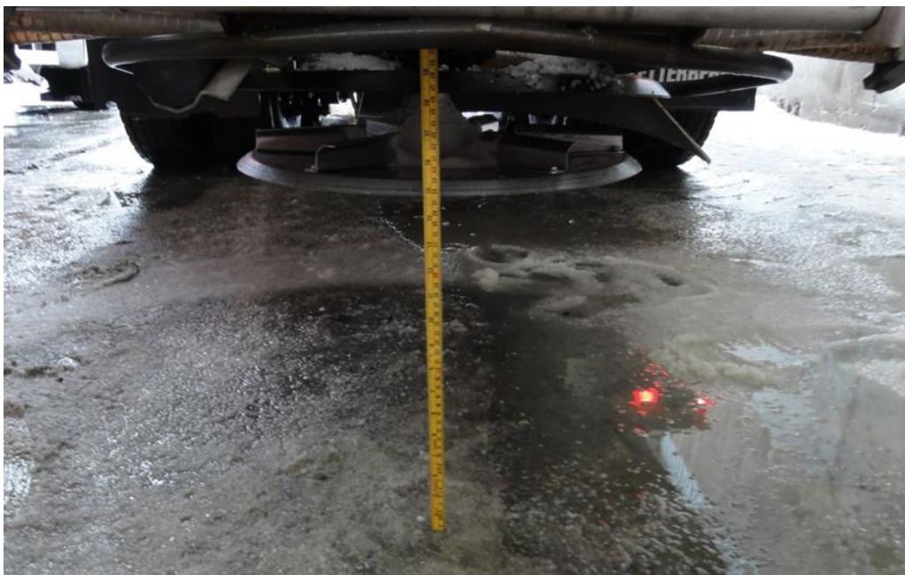
Figur 7-11 Måling av høyde på spredertallerken (Foto: Dagfin Gryteselv, Statens vegvesen)
