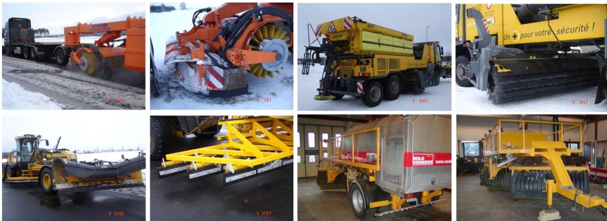
Figur 4-62 Spesialutstyr testet på Vålerbanen. RSS 200, Jet Broom, Slapsegrend montert på høvel og «Slapsekaren»
