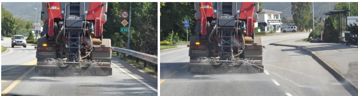
Figur 6-32 Varierende spredebredder styrt av GPS-posisjon (Foto: Dagfin Gryteselv, Statens vegvesen)
