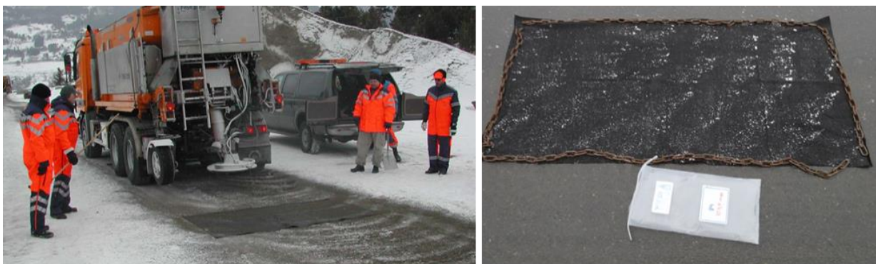
Figur 6-22 Kontroll av utstrødd mengde strømateriale med utlagte duker (Foto: Torgeir Vaa og Stein Hoseth)
