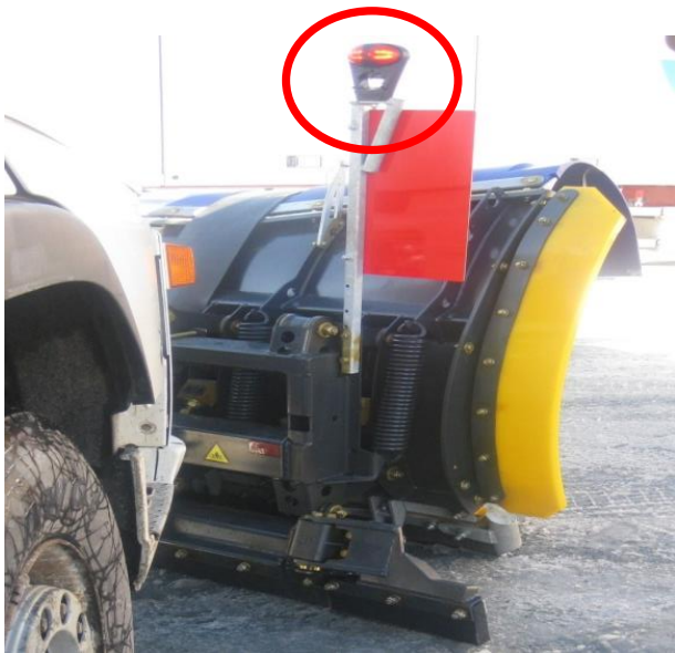
Figur 4-10 Markeringslys og merking bak på plog
