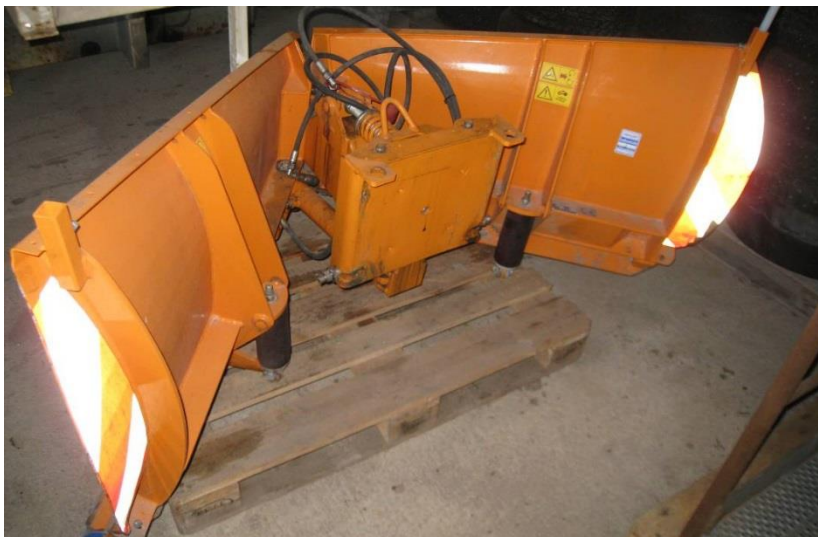
Figur 4-52 Eksempel på plog egnet for arbeid på gang- og sykkelveger
