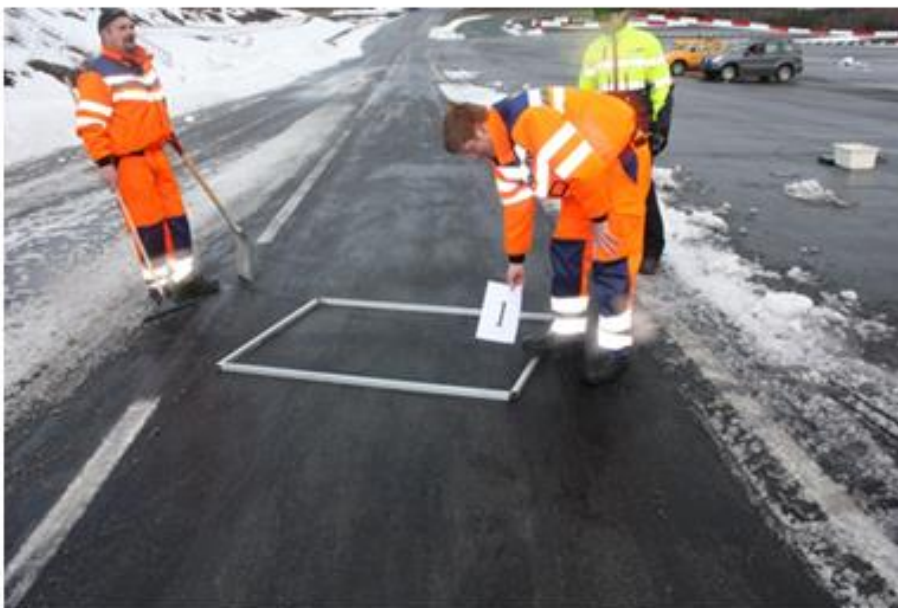
Figur 4-60 Mengde snø før og etter tiltak ved brøyting i 40 km/t. Det meste av snø/slaps er fjernet. (Foto: Statens vegvesen)
