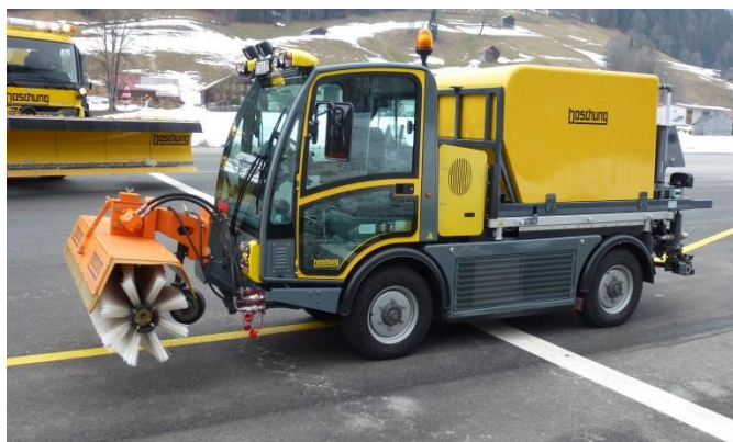
Figur 6-11 Eksempel på utstyr for gang- og sykkelveger med frontmontert kost og dysespreder (Foto: Dagfin Gryteselv, Statens vegvesen)
