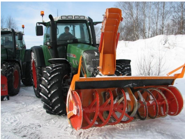
Figur 4-48 Frontmontert snøfres (Foto: Tellefsdal)
