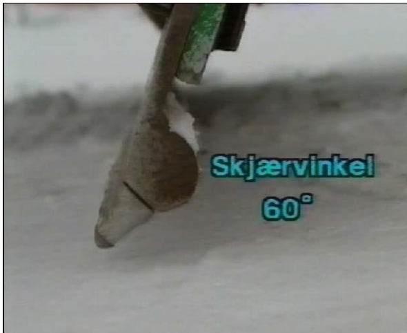
Figur 4-78 Riktig skjærvinkel med hardmetallstift (System 2000)
