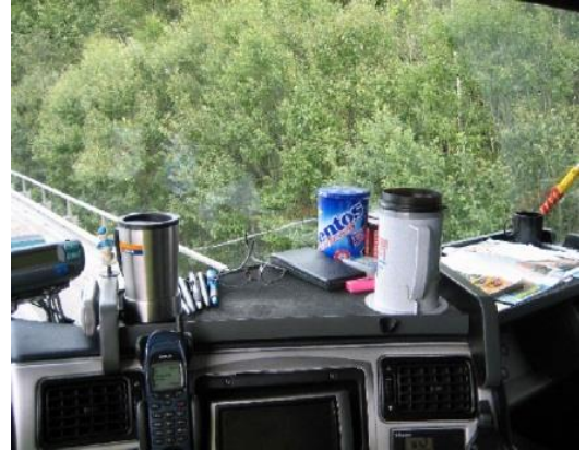
Figur 2-68 Gjenstander på ettermontert bord skaper blindsoner (de grønne «armene» i figuren til venstre)
