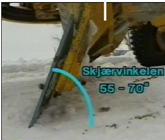
Figur 4-77 Riktig skjærvinkel mellom høvelskjær og underlag
