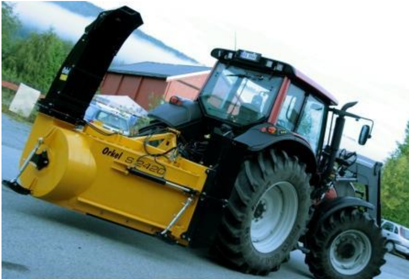
Figur 4-47 Bakmontert v-fres på traktor (Foto:Orkel AS)
