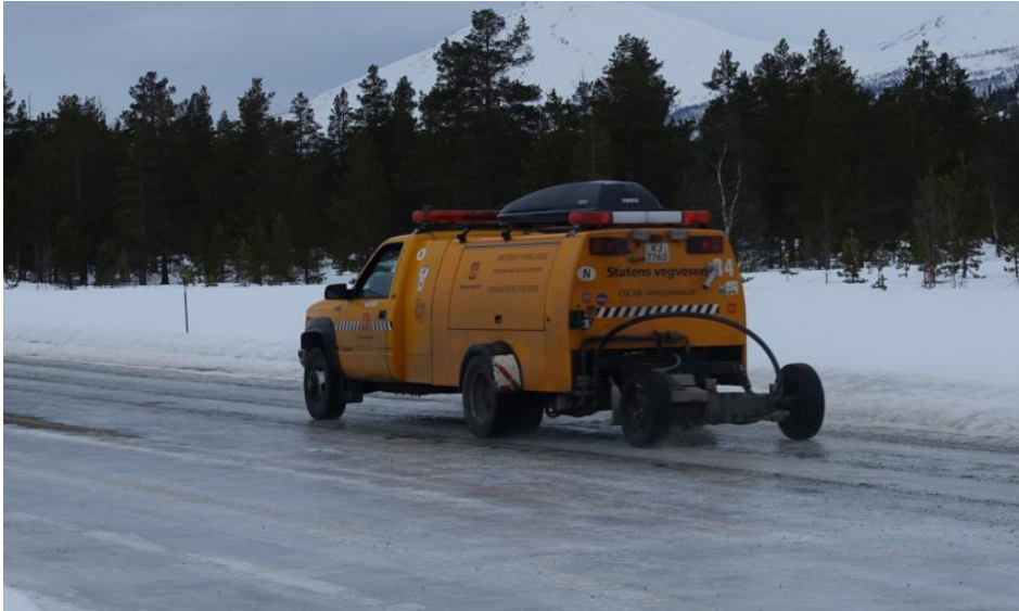
Figur 5-12 Friksjons- og referansemåleren OSCAR i aksjon på glatta (Foto: Bård Nonstad, Statens vegvesen)
