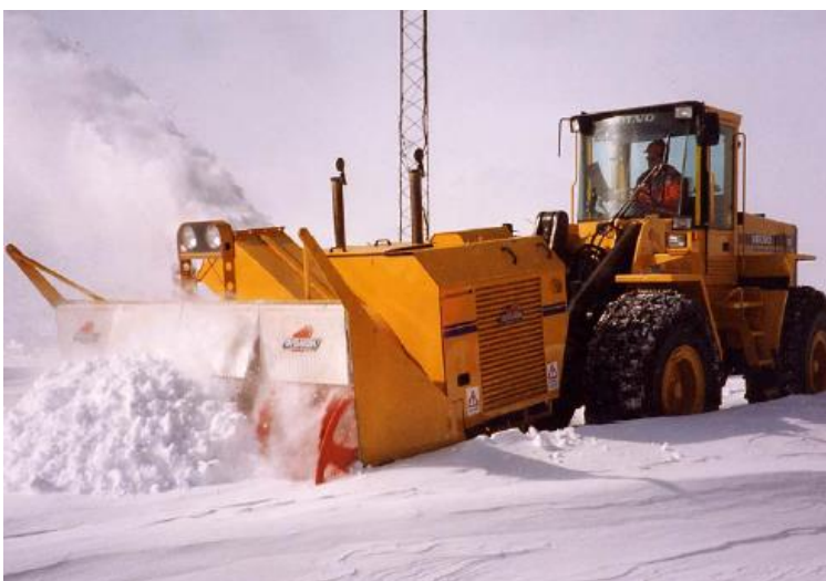
Figur 4-83 Unit-fres tilkoblet hjullaster (Foto: Øveraasen)
