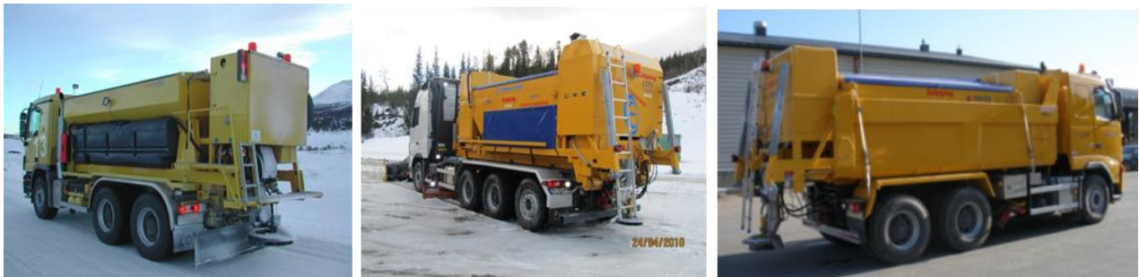
Figur 6-1 F.v.: Rammemontert, krokløftmontert og planfastspent strøapparat (Foto fra venstre: Torgeir Vaa, Anders Svanekil og Falköping)
