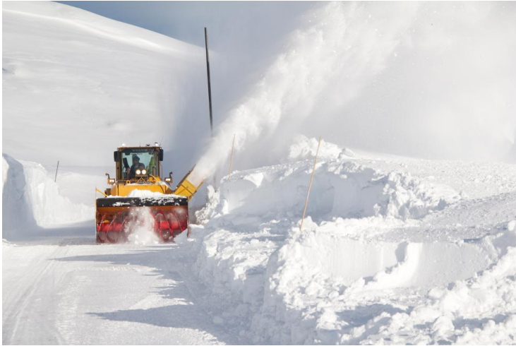
Figur 4-94 Rydding av brøytekanter, rv. 13 Vikafjellet (Foto: Sogn Avis)
