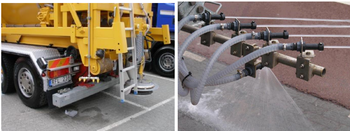
Figur 6-7 Strøapparat for høyhastighetsspredning (Foto: Falköping til venstre og Epoke til høyre)
