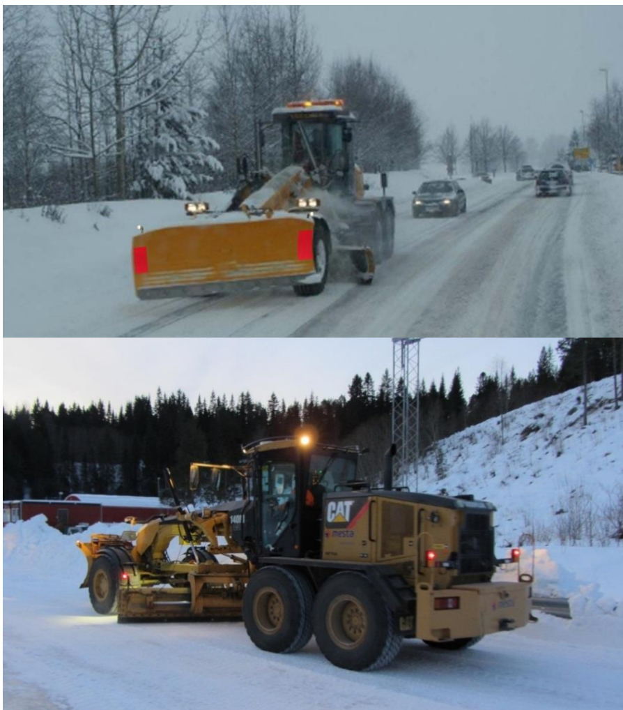
Figur 4-21 Veghøvel med isriverskjær og frontblad (Foto: Statens vegvesen)
