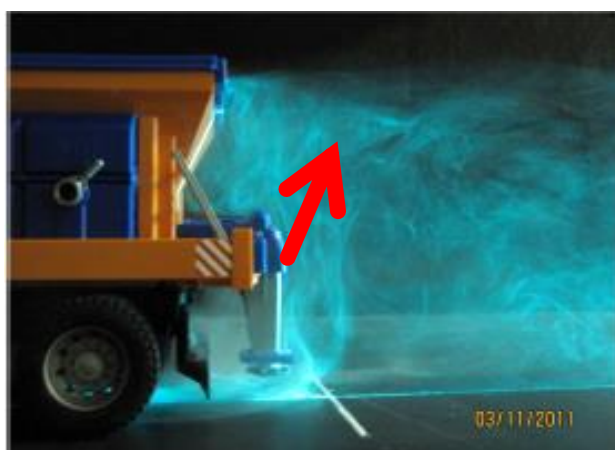
Figur 6-28 Vertikale luftstrømmer bak en lastebil i fart
