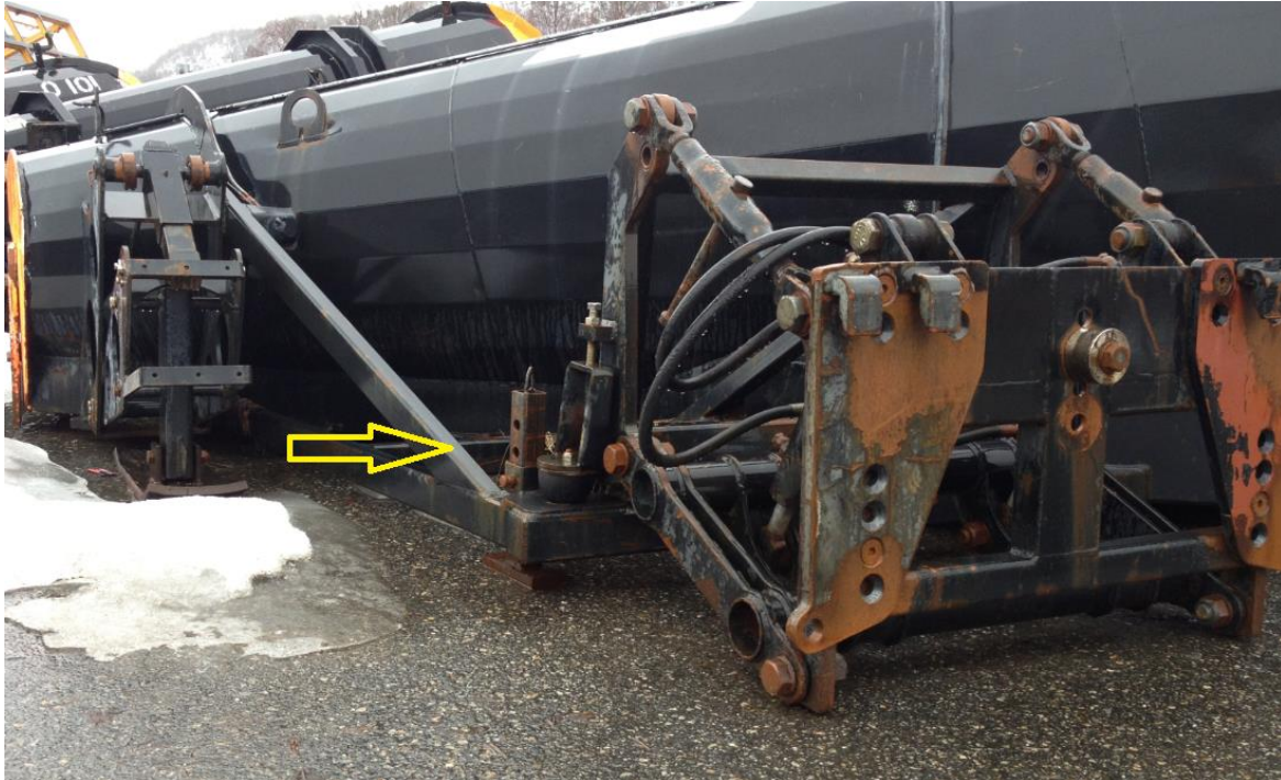
Figur 4-17 Eksempel på parkeringsfot på diagonalplog
