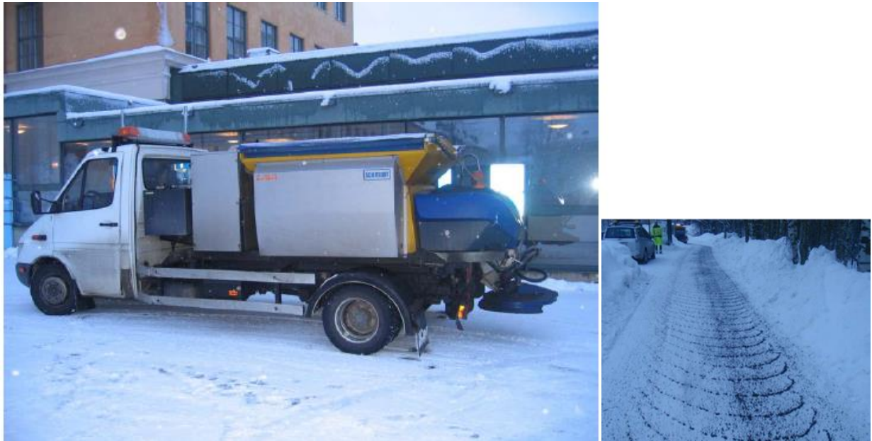
Figur 6-15 Kjøretøy for fastsandspredning på gang- og sykkelveger som er benyttet i Umeå kommune (prototype) (Foto: Anna Niska, VTI Sverige)
