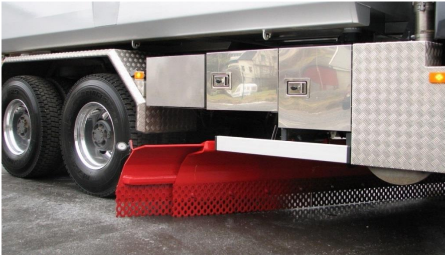
Figur 4-35 Underliggende skjær (Foto:Tellefsdal AS)
