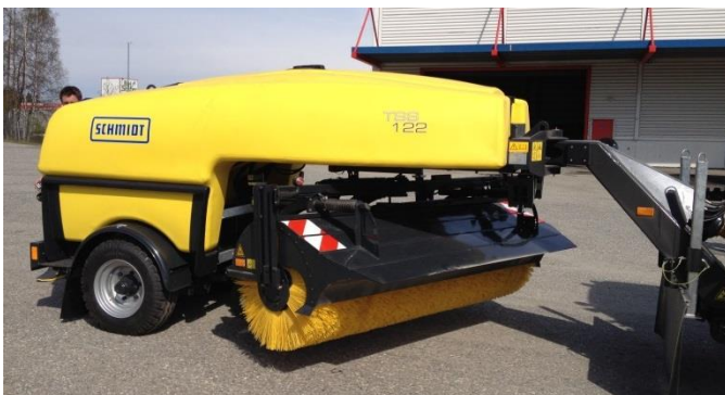
Figur 6-14 Roterende kost og løsningsspreader for gang- og sykkelveger. Trekket av en traktor. (Foto: Dagfin Gryteselv, Statens vegvesen)
