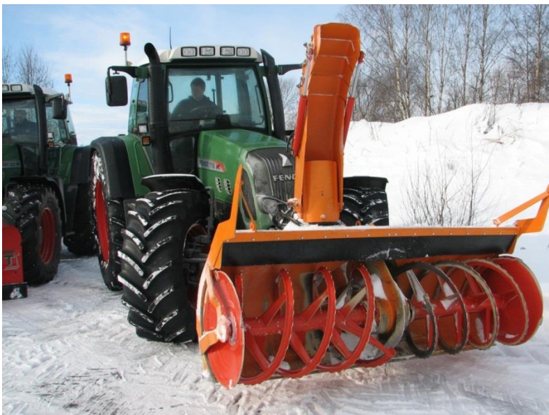
Figur 4-81 Frontmontert snøfres på traktor (Foto: Tellefsdal)
