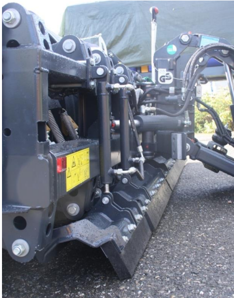
Figur 4-43 Gummiskjær/lameller montert bak på plog (Foto: Schmidt Norge AS)
