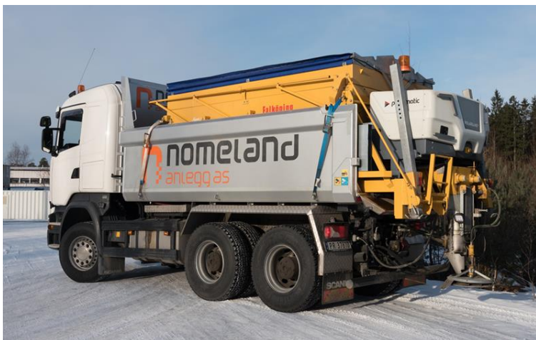
Figur 6-6 Varmsandspreder (Foto: Normeland Anlegg)
