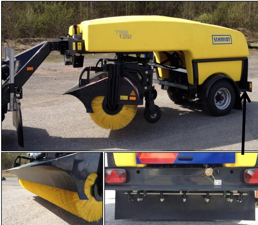
Figur 4-51 Eksempel på traktormontert etterhengende sweeper med saltløsnings-spreader (Foto: Dagfin Gryteselv, Statens vegvesen)
