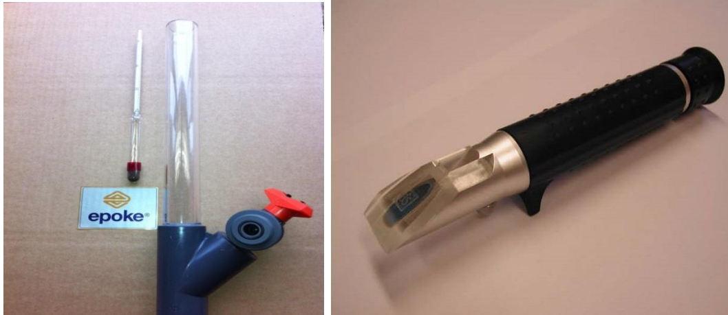
Figur 8-6 Eksempel på utstyr for måling av saltkonsentrasjon i løsning (Foto: Statens vegvesen)
