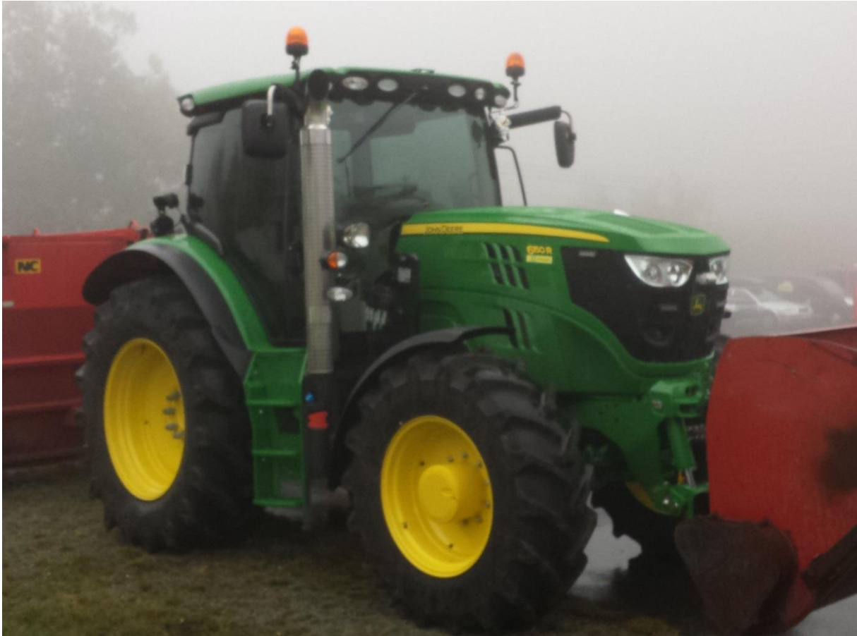
Figur 2-81 Sotede vinduer på brøyterredskap hindrer øyekontakt mellom brøytesjåfør og myke trafikanter
