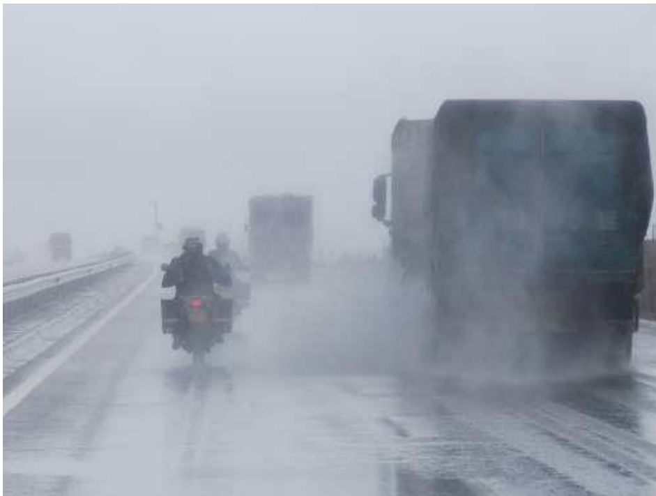
Figur 6-25 Oppvirvling fra vegoverflate
