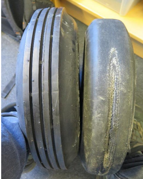
Figur 5-14 Bildet viser et nytt måledekk (til venstre) og et totalt utslitt måledekk (til høyre) (Foto: Rune Pettersen, Viatech AS)
