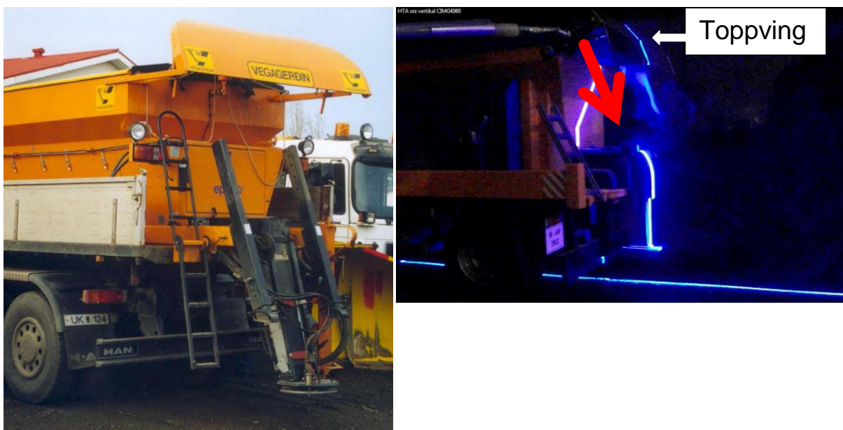
Figur 6-29 En toppvinge (spoiler) vil kunne redusere luftstrømmen opp bak bilen
