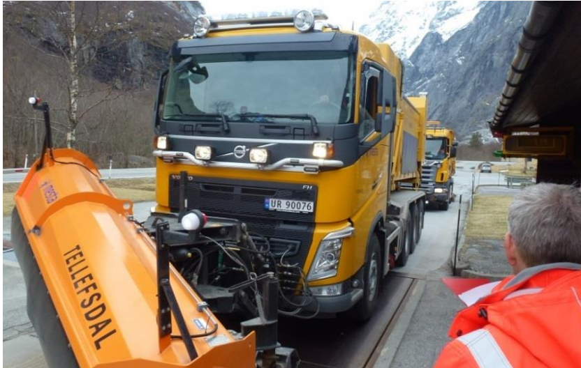
Figur 6-23 Veiling av kjøretøy før og etter strøing (Foto: Dagfin Gryteselv, Statens vegvesen)
