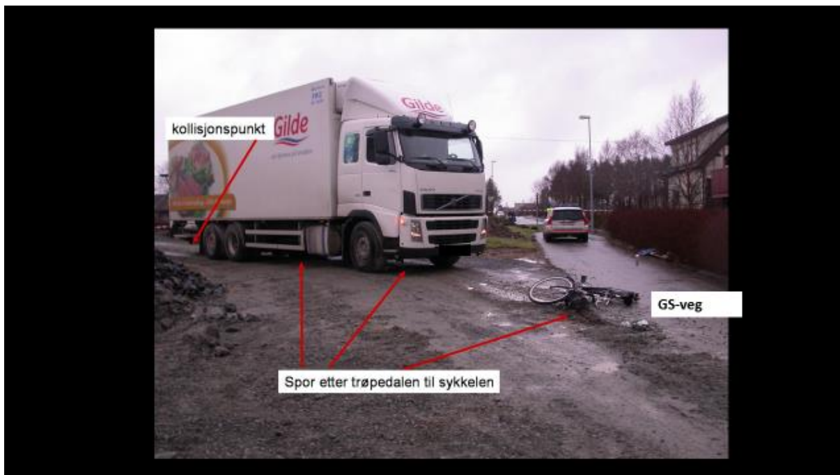
Figur 14: Bildet viser et kryssområde mellom en gs-veg og en avkjørsel til et anleggsområde. Deler av gs-vegen ble benyttet som adkomst til anleggsområdet. En syklist ble påkjørt av en lastebil da han passerte foran kjøretøyet. Lastebilen benyttet den midlertidige anleggsvegen i forbindelse med varelevering i det området hvor anleggsarbeidet pågikk.
