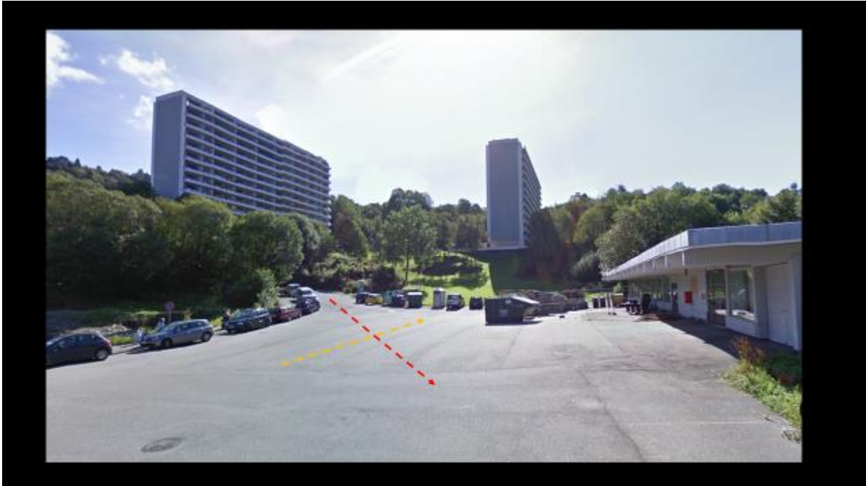
Figur 11: Bildet viser et område hvor det foregikk anleggsarbeid i enden av P-plassen. En fotgjenger (rød pil) ble påkjørt av en lastebil som var i ferd med å rygge fram til anleggsområdet (gul pil). Anleggsområdet var ikke avsperrret og passerende fotgjengere og syklister ble ikke ledet utenom anleggsområdet på en trygg måte.
