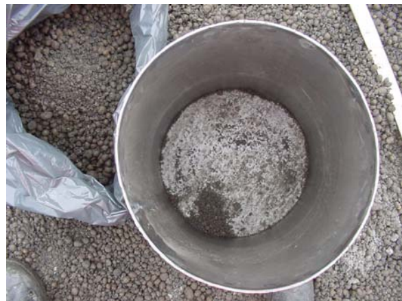
Figur 6: Prøvetakingsrøret presset ned til fiberduk
