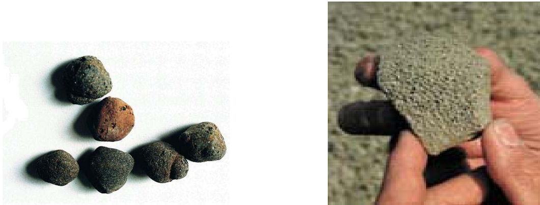
Figur 1 – Leca Lettklinker til venstre, Hasopor skumglass til høyre
