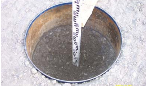
Figur 79: Densitetsprøve, G/S-veg Lodalen
