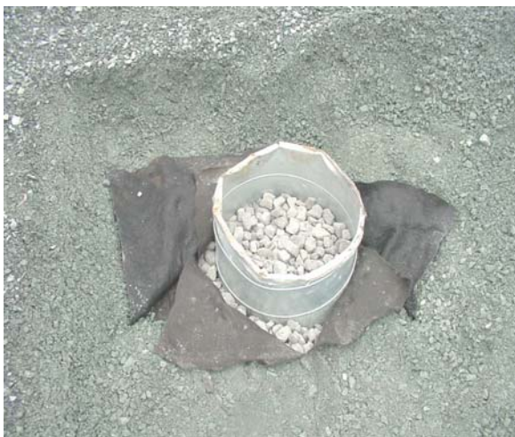
Figur 92: Densitetsprøve i skumglass, E6 Mulekrysset
