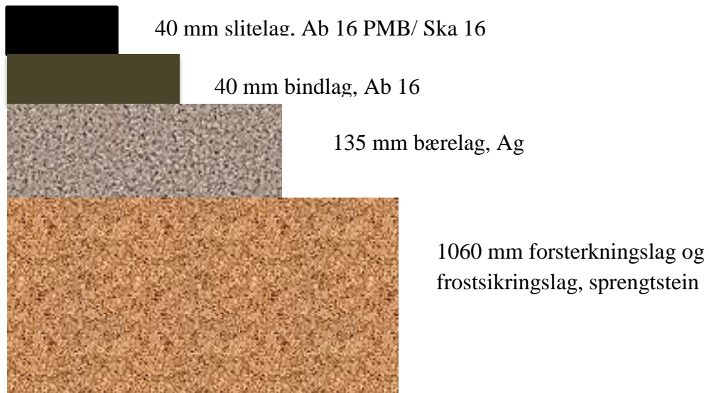
Figur 2 Overbyggingskonstruksjonen på teststrekningene
