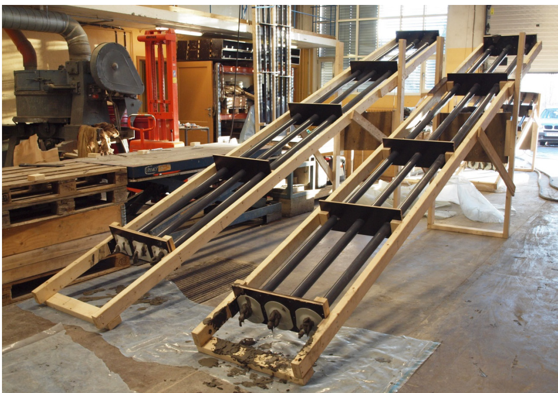
Foto 2 Batterier for 5 m lange bolter montert på skrå (20° fra horisontalen)
