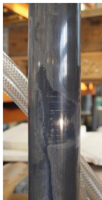
Foto 8 Eksempel på PVC-rør med kamstålbolt med plasthylse etter gysing med vanninntrenging
