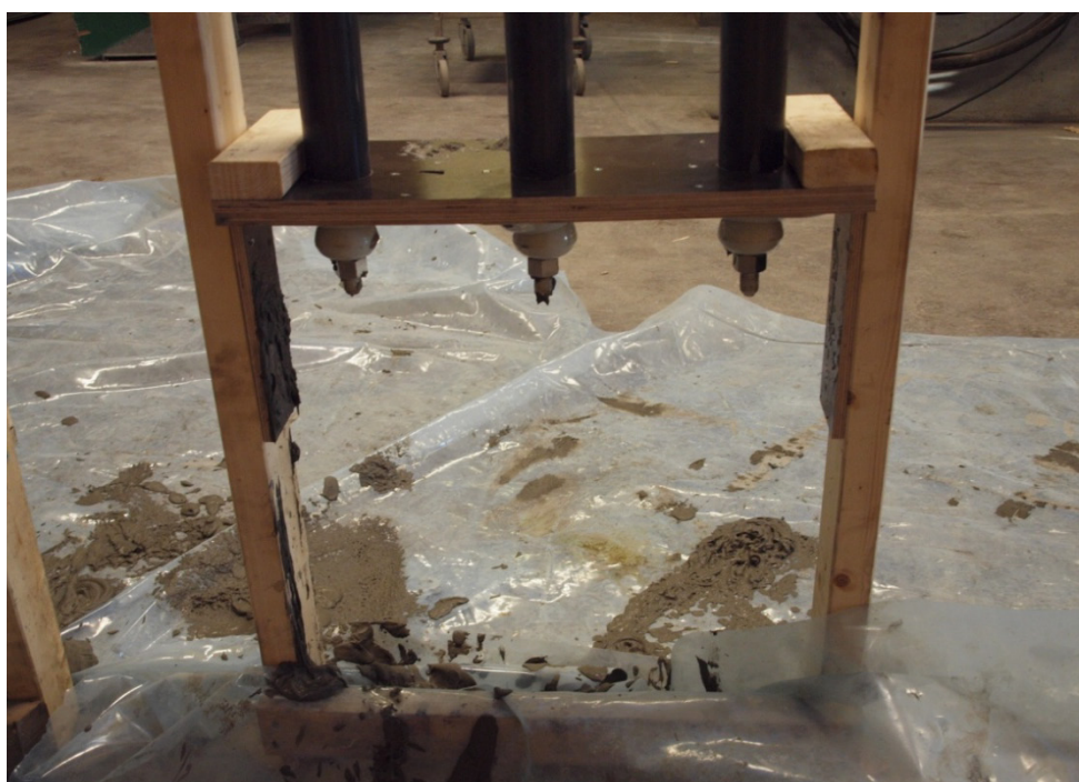
Foto 6 Kamstålbolter med plasthylse (5 m) etter gysing med v/c+s = 0,43
