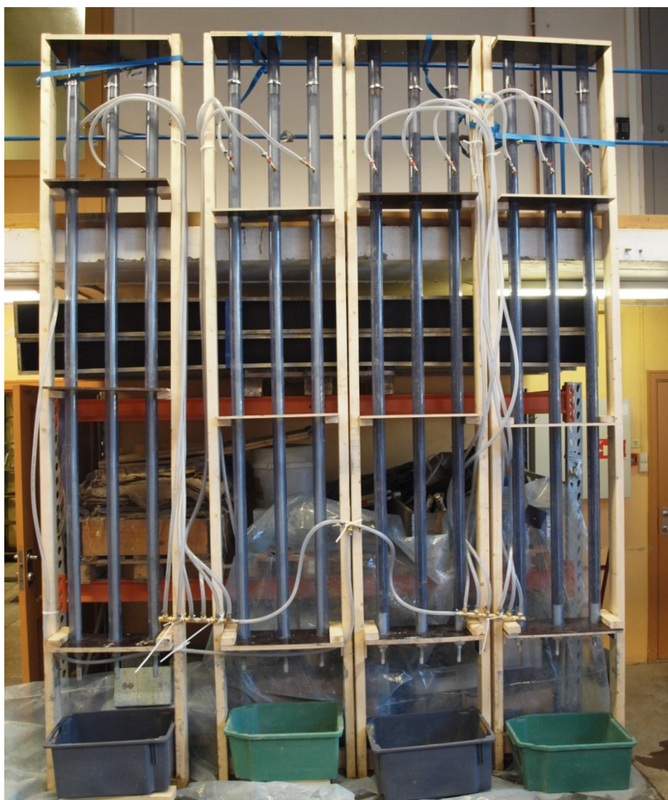
Foto 7 Rigging av 4 batterier for forsøk med vanninntrenging i plastrørene
