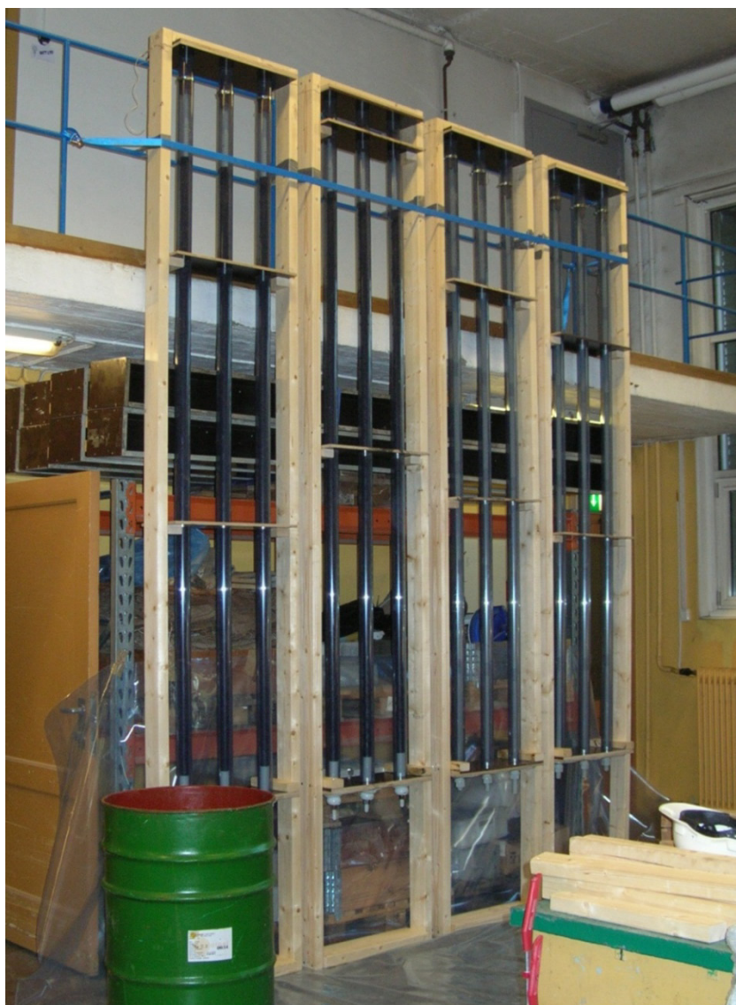
Foto 3 Innledende forsøk, rammer med 3 m lange bolter montert vertikalt
