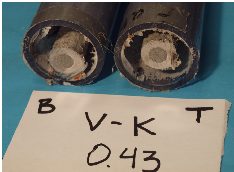
Foto 19 Pc-rørbolt saget 0,5 m fra topp og bunn (3 m vertikal bolt, v/c+s lik 0,43)
