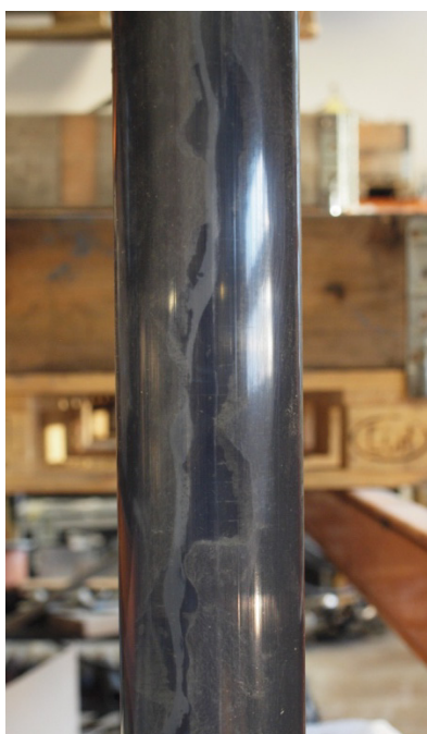
Foto 8 Eksempel på PVC-rør med kamstålbolt med plasthylse etter gysing med vanninntrenging
