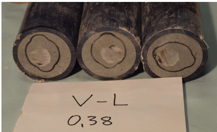
Foto 16 Kamstålbolt med plasthylse saget ca 35 cm fra ekspansjonshylsa (5m vertikal bolt, v/c+s lik 0,38).
