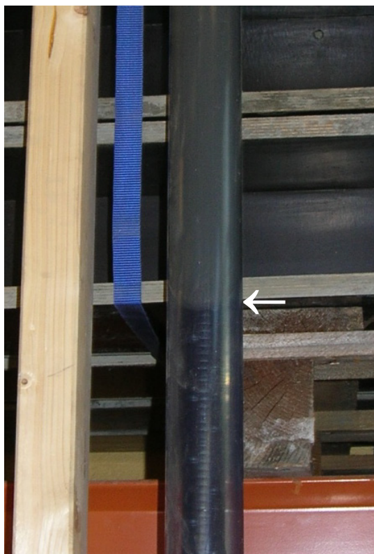
Foto 13-14 Typisk gyseforløp ved gysing av vertikale rør (rørbolt til høyre og kamstålbolt med plasthylse til venstre)
