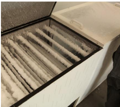
Figur 4.2 Produksjon av kunstig fersk snø for laboratorieforsøk.
