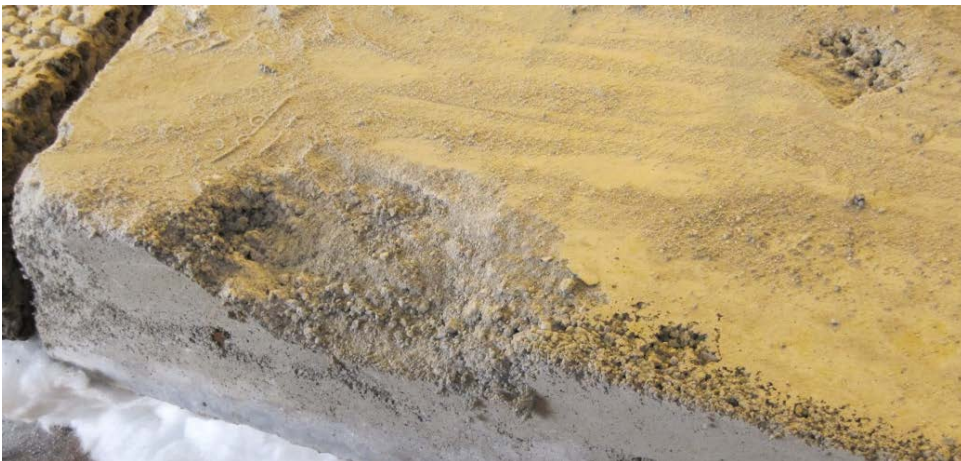
Figur 12 Sår i testelementene tyder på at mye prell ble sprøytet inn i formene
