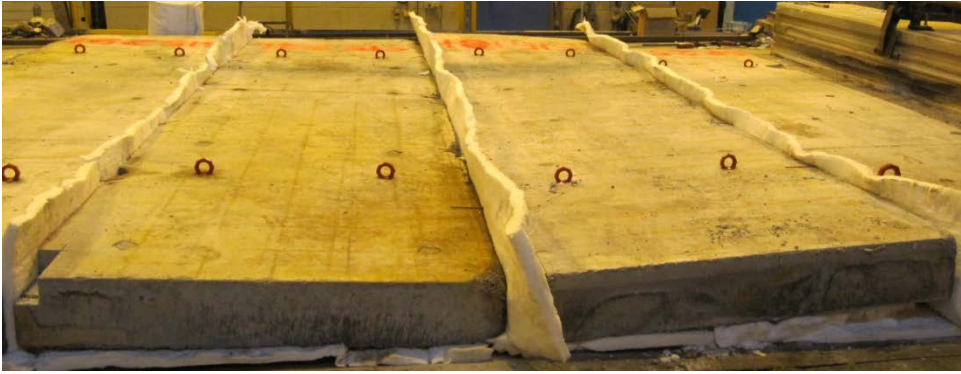
Figur 11 Vindskjeve testelementer av sprøytebetong montert på testovn før brannprøving
