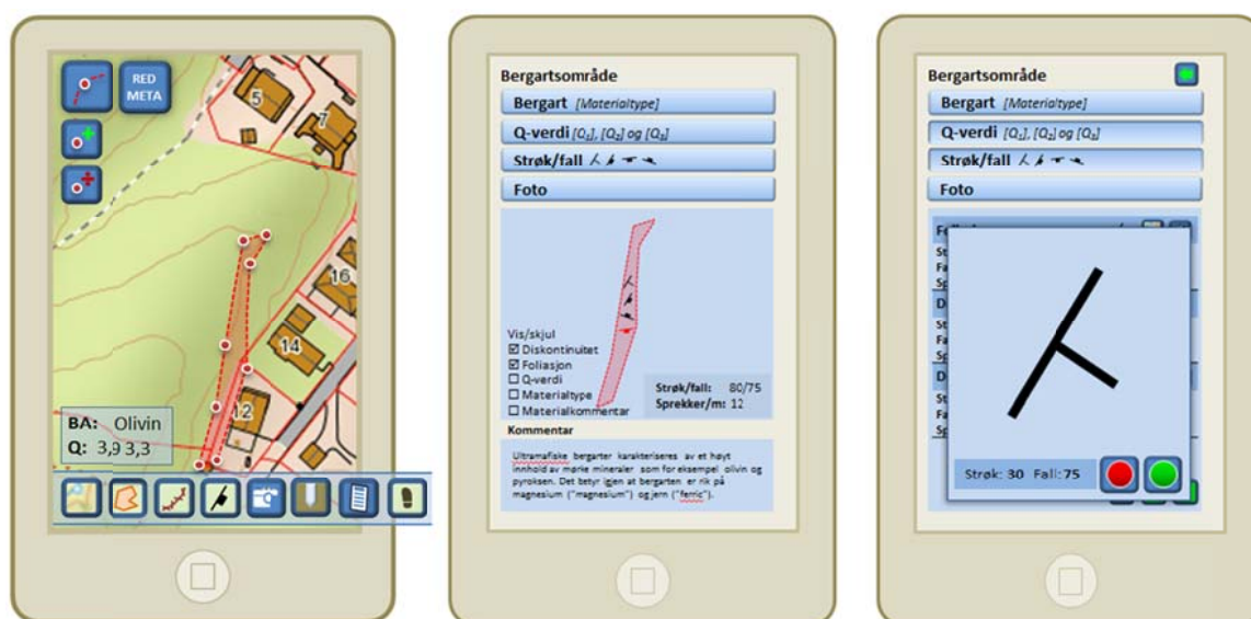
Figur 30. 1) Registrering av et bergartsområde på kartet direkte på skjermen. 2) For alle registreringer kan man legge inn metadata. For bergartsområder kan man legge inn type bergart (samt struktur tekstur etc.), Q-verdier Strøk og fall på foliasjon og sprekksett og foto. 3) Man skal kunne legge enheten på en flate og måle strøk og fall automatisk med sensorene med et enkelt trykk.
