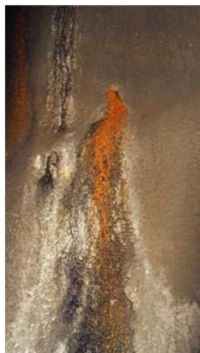
Figur 24. Testfeltet for sprøytebetong med vekst av biofilm
