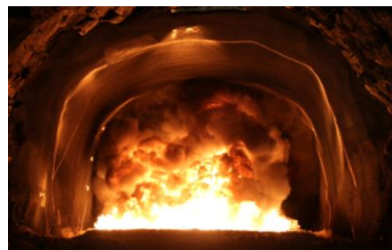
Fullskala brannforsøk i Runehamar Test Tunnel. Foto: Sandra H. Steinbakk, SINTEF NBL
