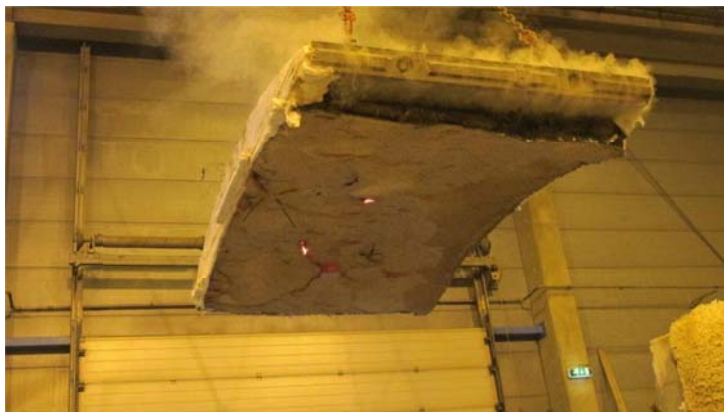
Figur 12 Krumt element med PE-skum montert som “styrt profil” med 8 cm nettarmert sprøytebetong uten pp-fiber. Store avskallinger etter få minutter i HC-brann (opp til 1100°C), med antenning av PE-skum ved testens slutt. Foto: Karen Klemetsrud, Statens Vegvesen.
