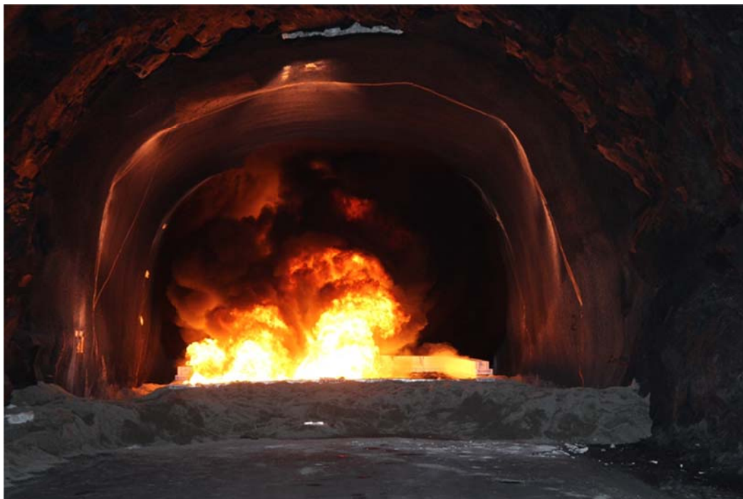
Figur 13 Start av 100MW brann (19000l diesel) i Runehamar testtunnel. Foto: SINTEF NBL AS/ Sandra H. Steinbakk
