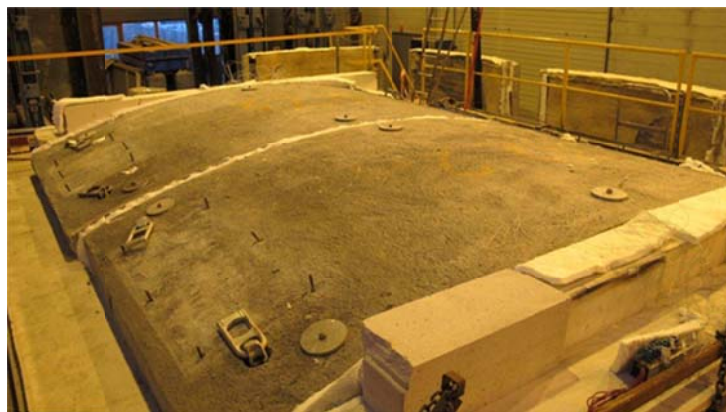
Figur 11 Krumme element med PE-skum montert som “styrt profil” med 8cm nettarmert sprøytebetong. Ligger ferdig plassert på horisontalovnen, klar til to timer HC-brann (opp til 1100°C). Foto: Karen Klemetsrud, Statens Vegvesen.
