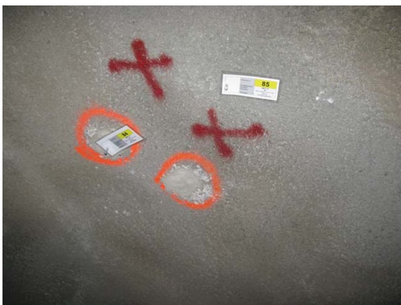
Figur 1: Merking av prøvested med rødt kryss og feste av merkelapp med prøvenummer.
