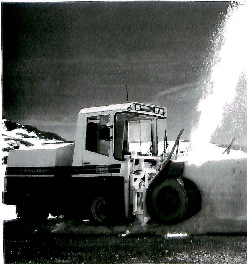
Skilnaden frå ein konvensjonell vedlikehaldsfres er at heile fresen (Schmidt Supra 2000) utgjør ein komponent, i staden for den vanlege samankoplinga mellom unifres og hjullastar.
