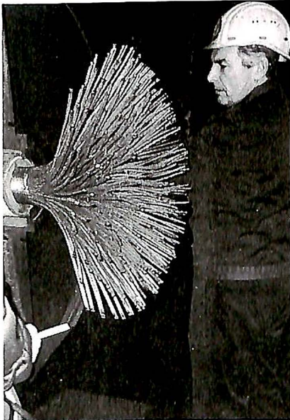
Fra kabelproduksjonen i Gelsenkirchen. Kabelen blir behandlet før hodet blir påstøpt. (Foto: Bjørn Tore Wiik.)
