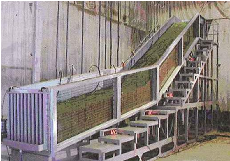
Fig 3.15. Foto av renne for gjennomføring av modellforsøk med utløsning av flomskred, Ochiai et al (2007).
