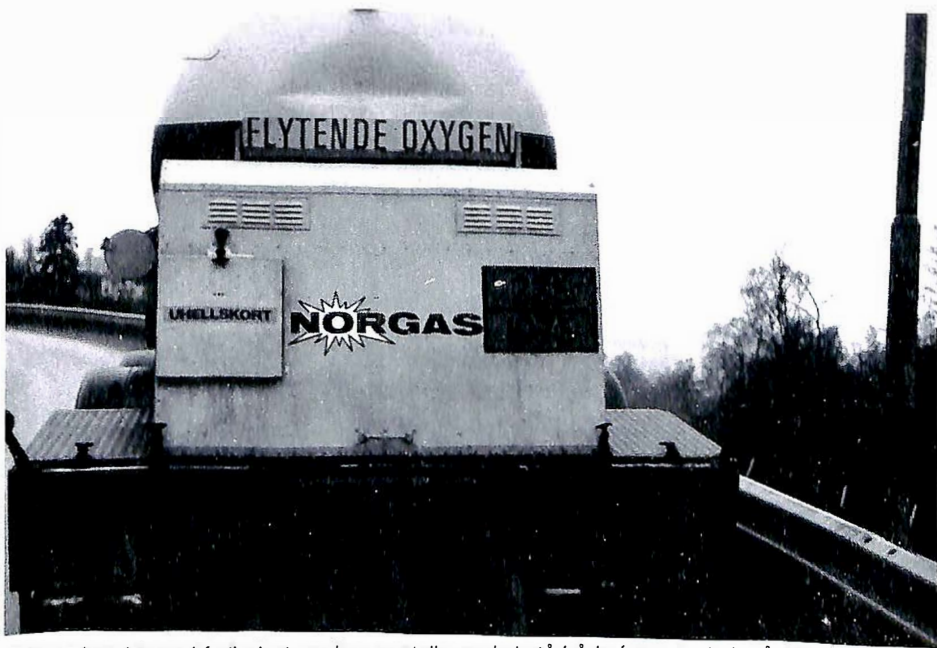
Slik skal en bil med farlig last merkes, og tallene skal stå både foran og bak på bilen.
