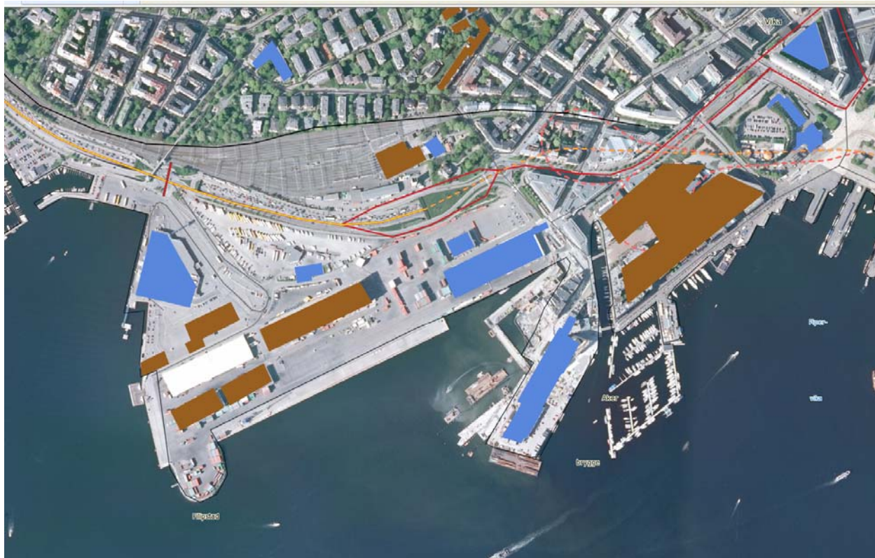
Figur 13 Luftfoto av Festningstunnelens vestende ved Framnes (Arealis). Tunnelen er markert med stiptet gul linje midt i bildet. Området ved jernbanesporene og inn mot bebyggelsen er lavere enn kaifronten, og eventuelt overvann vil strømme inn fra vest og dreie mot sør i retning tunnel-åpningen.
