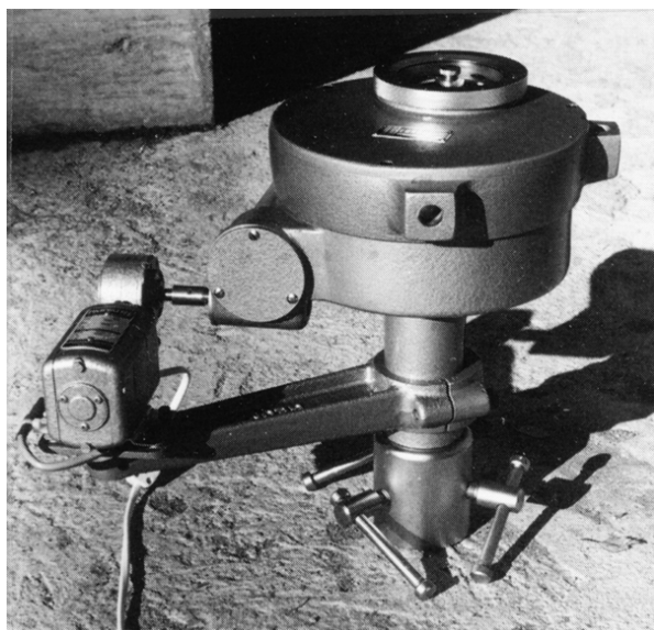
Figur 15.221-3 Vingeboringsinstrument med elektrisk drift
