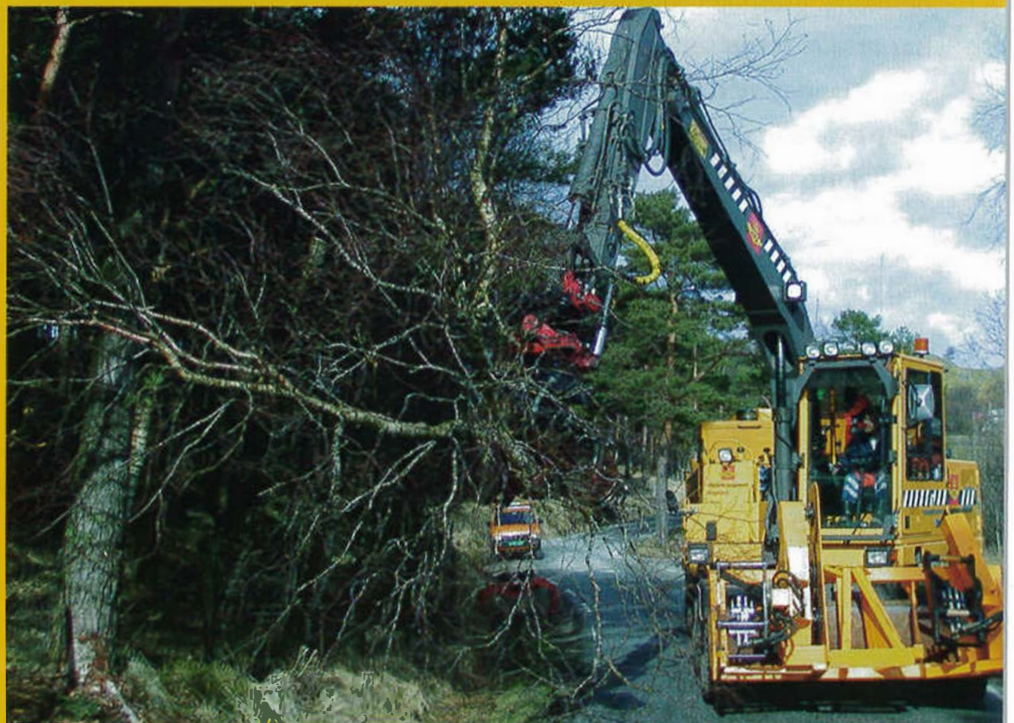
Frå ein hjulgåande gravemaskin og med hurtigkopling av utstyr, blir vegkantane effektivt rydda for både kratt, greiner og store tre. Foto. Per Skårland.
