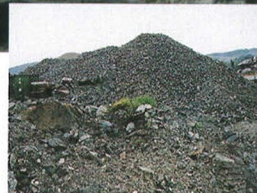
Litt av pukkhaugen som Statens vegvesen Telemark har knust opp av utsprengd stein frå anlegget.
