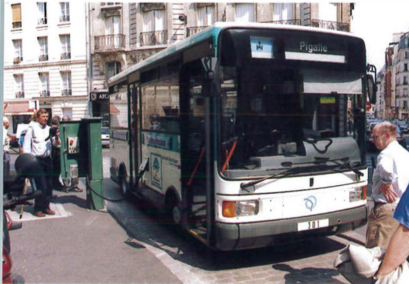
Elektrisk buss i ordinær rutedrift på Montmatre i Paris. Bussen blir hurtiglada ca 4 min pr rundtur.
