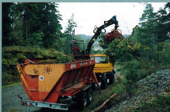
Kverna blir også brukt ved rydding langs vegkantar. Her blir store tre knust til småflis.
