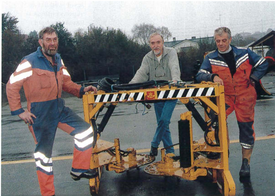
Oppfinnarane. John Mathias Vikingstad (t.v.), Torleiv Tveit og Olaf B. Kallevig, med den høgt premierte maskinen. Me ser dei to klippeelementa som «smyg» seg rundt rekkverkstolpane. Under klippeelementa er det festa kjettingar som slår graset rundt heile stolpen. Foto: Harald Sel
