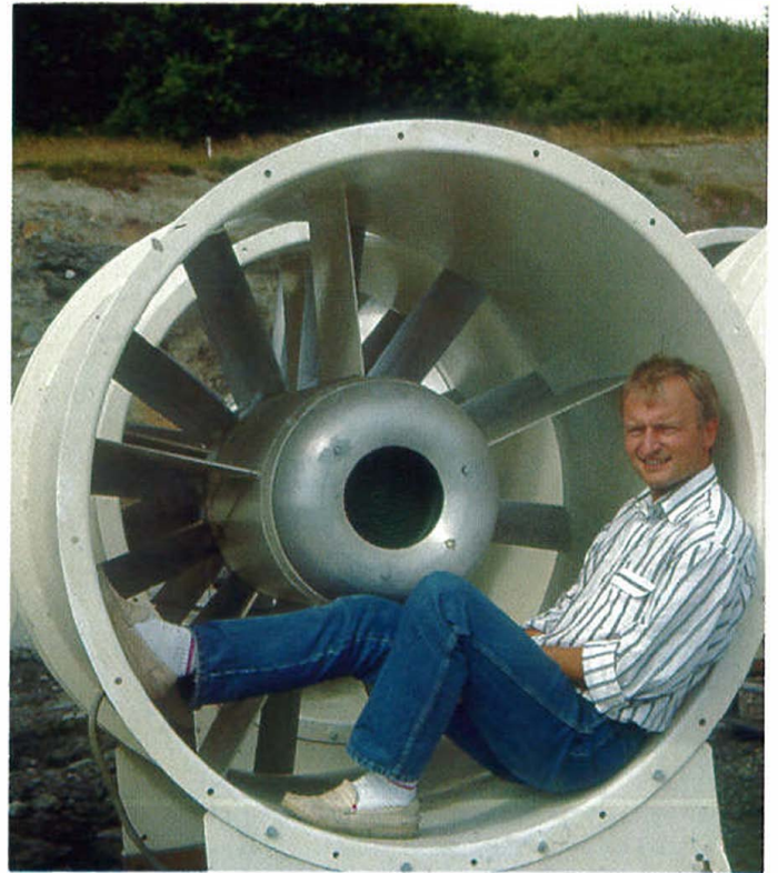
Store dimensjoner over ventilatorene som skal sørge for god luft i tunnelene. Prosjektleder Tor Geir Espedal får god plass i vifte-inntaket.
