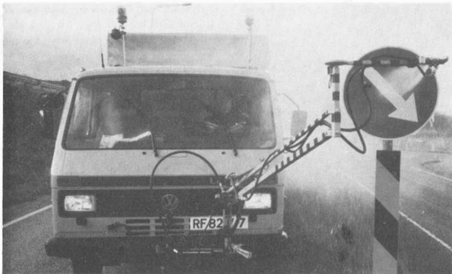
Ved denne metoden styres hele vaskeprosessen, utenom dysens vertikalvinkel, fra bilens førerplass.
