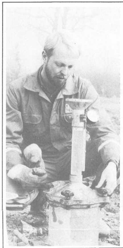
Teknisk kvalitetskontroll er viktig i anleggsarbeidet. Her er oppsynsmann Magne Langeteig frå laboratoriet i arbeid med å kontrollera betongen ved støypinga av dekket.
