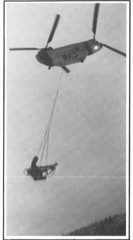
Helikoptertransport av boreriggen, som blei plassert i ulendt terreng oppe i fjellsida ovanfor rasstaden.
