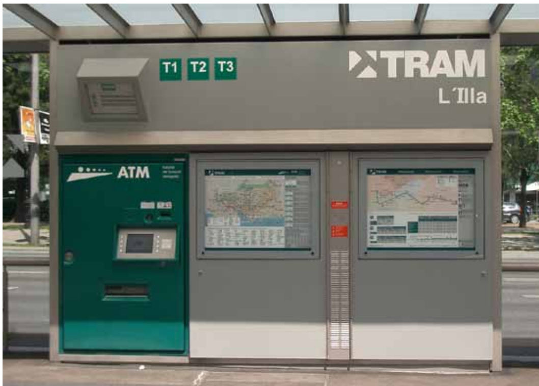
Barcelona, Spania. Holdeplassdesign med billett-automat, ruteinformasjon, nødalarm og billettinformasjon. Foto: Finn Aslaksen.
