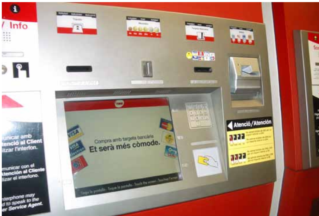
Automat Barcelona. Skjermen har ramme med punktskrift og taleinformasjon. Maskinene har et navigasjonssystem som ved hjelp av punktskrift og talemeldinger leder kunder med synshemminger gjennom prosessen med å kjøpe billett. Foto: Finn Aslaksen.
