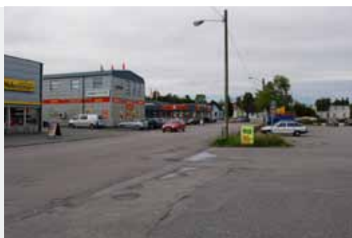
Skippergata, Porsgrunn. Eksempel på utflytende, gate-miljø med store parkeringsarealer. Slike har ofte store asfaltflater med en blanding av biltrafikk, gående og parkering, der overgangene er uklare. Fortauet er usammenheng-ende med mange kryssende avkjøringer uten ledelinjer.
