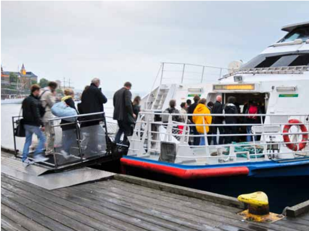
Hurtigbåt med trinnfri ombordstigning. Bildet viser Nesoddbåten, Oslo. Foto: Knut Opeide.
