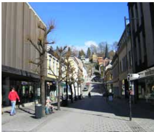
Telemarksgata, Skien. Her er det en bred og en smal møbleringssone og tre ferdelszoner, med den bredeste i midten. Trær og møbler står i møbleringssoner og gangsonene er uten hindringer. Skillet mellom ferdelszoner og møbleringssoner er også ledelinjer. Foto: Elin Katrine Nilsen.
