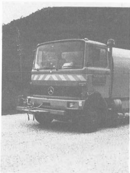
Etter at kvitsteinen har festet seg, blir all overflødig stein sopt bort. Feie-bilen kjører stadig over strekningen for å fjerne stein som måtte løsne.
