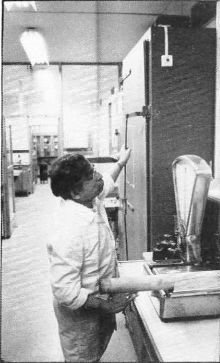
9. Hver enkelt sylindere med innhold blir nøyaktig veid før man går videre med analysene.
