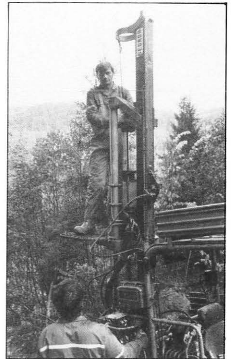
3. Når ønsket dybde er nådd, sikres innerstengene slik at de kun kan beveges ca. 3 cm. oppover. Prøvetakeren frigjøres fra stempelstangen (og innerstengene) ved å rotere disse 7-8 omdreininger. Utskjæring av hele prøven skjer under ett ved en rask, jevn nedpressing av ytter-rørene.
