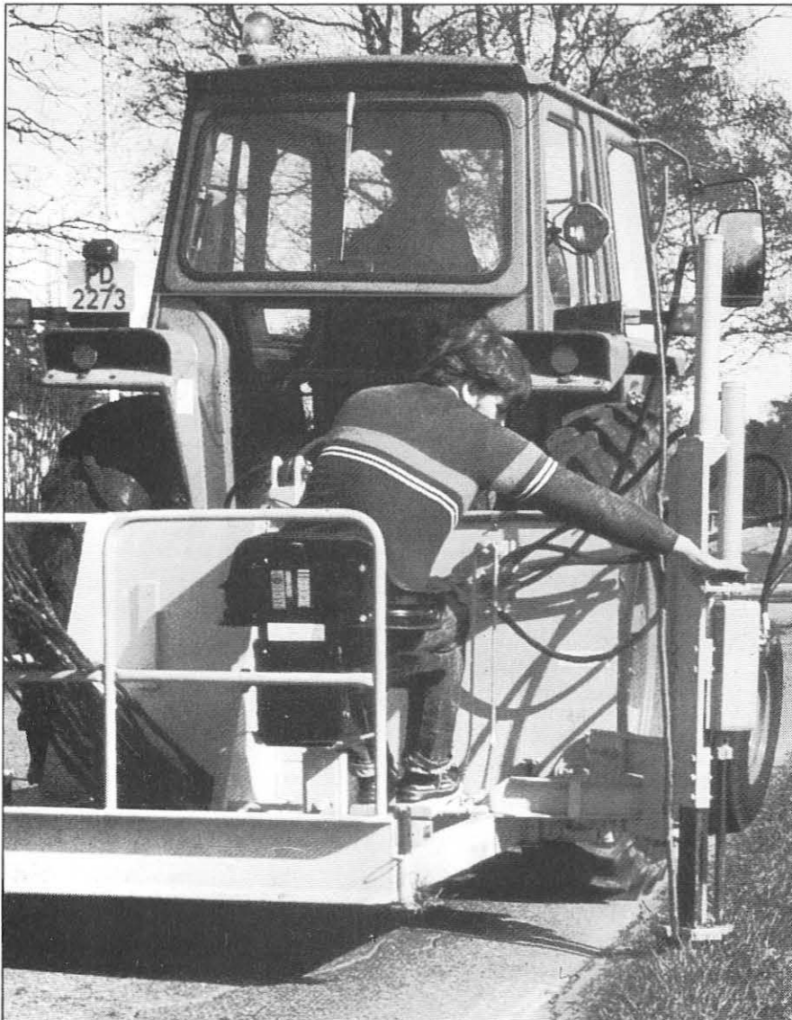
Utstyret montert bak på traktoren til oppfinneren selv. Operatøren har en arbeidsplass med ortopedisk riktig utforming — anbefalt av Arbeidstilsynet.
