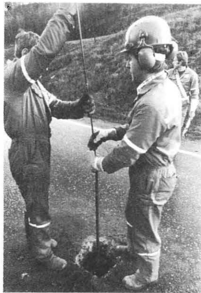
Telegrensemåleren monteres med anker for feste i undergrunnen
