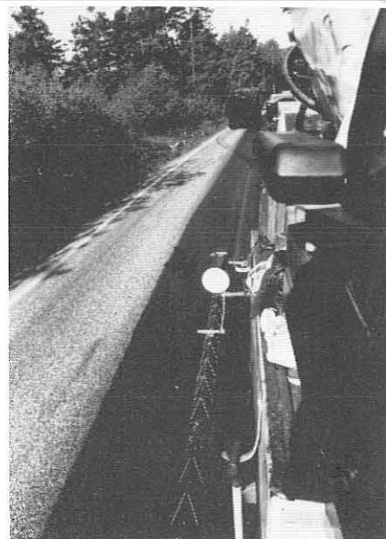
En manuell radar på utleggeren målte hastighet forbi denne
