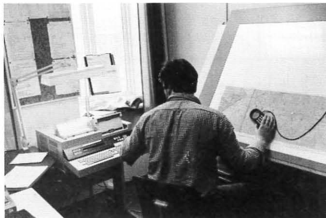
Etter hvert som digitaliseringsmaskinen t.v. spør etter nye opplysninger, puncher operatøren disse inn.
