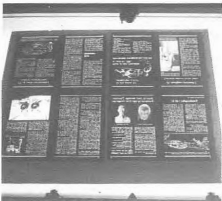
8 sider av gangen blir overført til negativ film.
