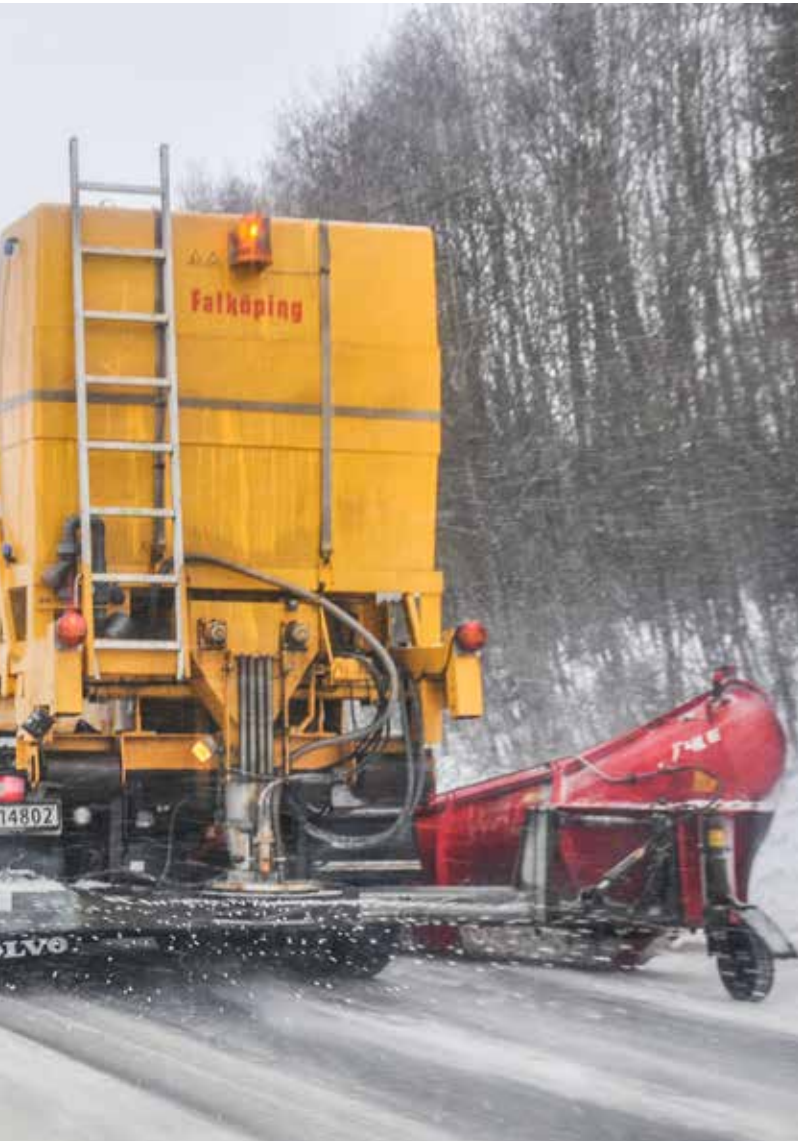
UNNGÅR SALT: Fastsand spres ut fra en modifisert tallerkenspreder, mye lik denne som sprer saltløsning på E6.
