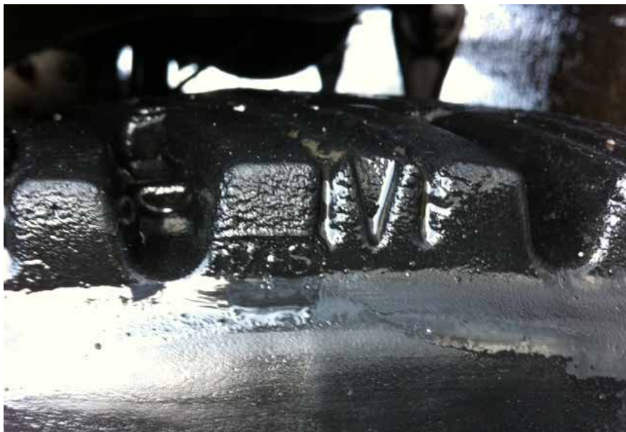
MANGLER: Dekk utan synleg merking
