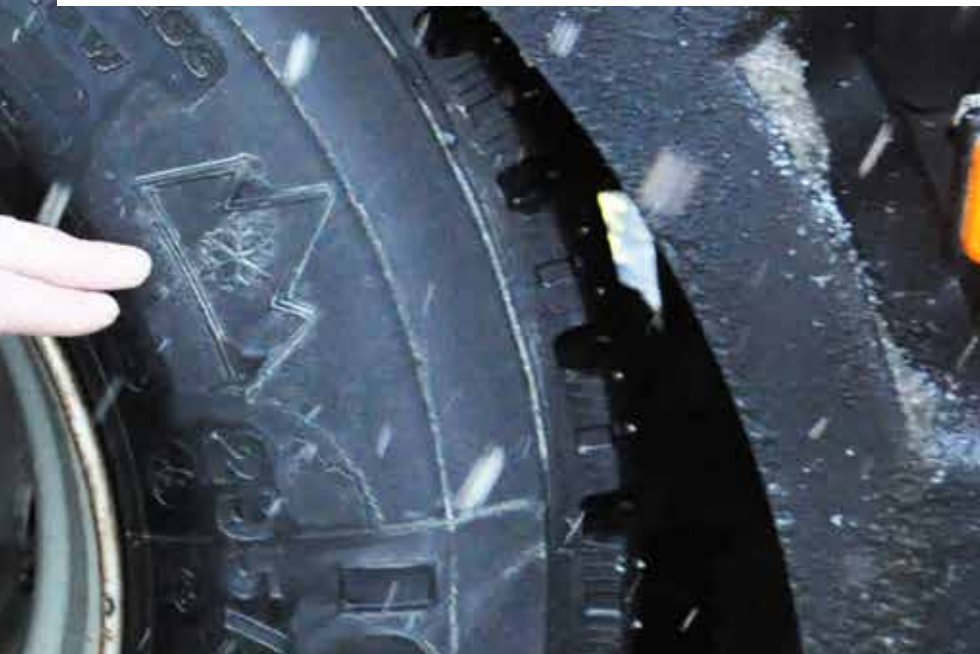
MANGLER: Dekk utan synleg merking
