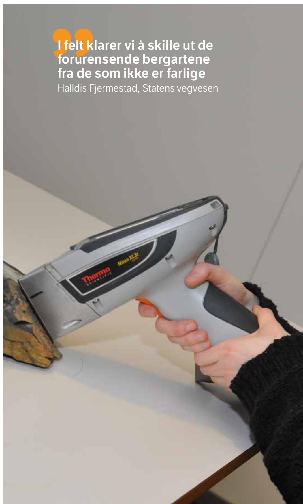
BRUKER RØNTGENSTRÅLER: Halldis Fjermestad demonstrerer instrumentet som kartlegger
