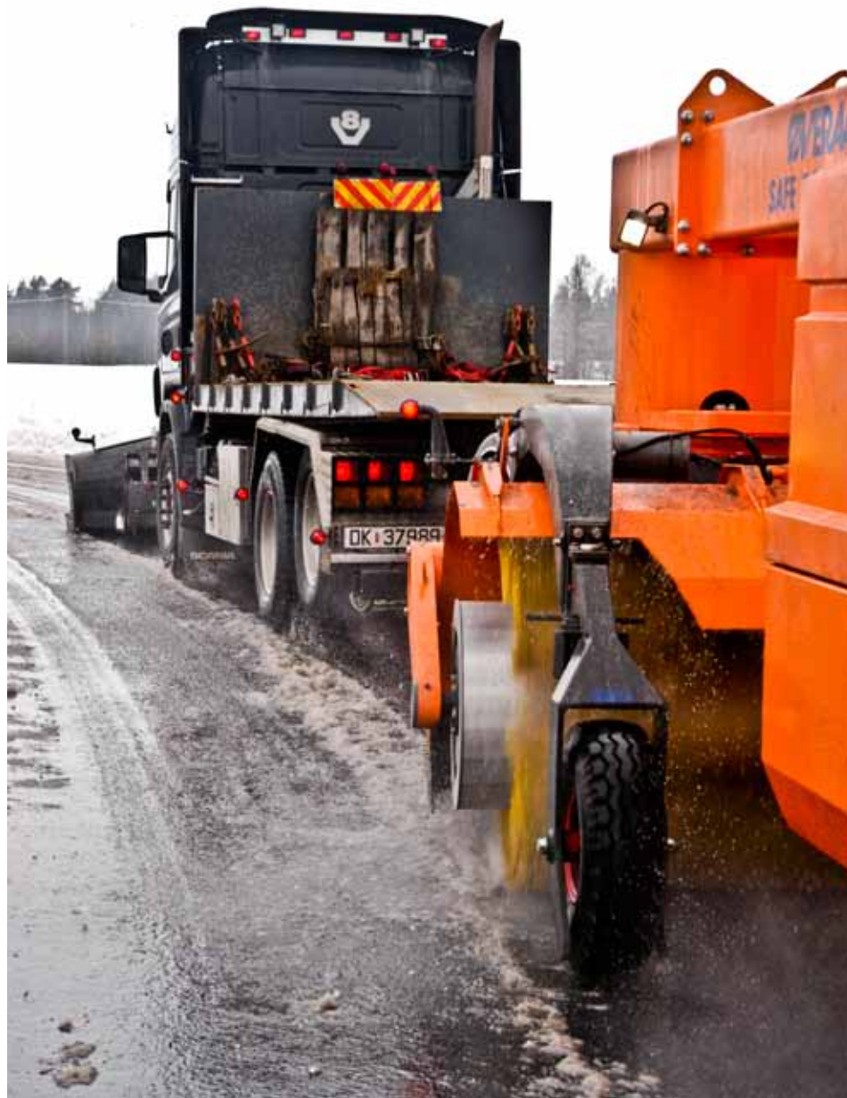
Statens vegvesen vurderer nye forsøk for å utvikle mekanisk utstyr som reduserer behovet for vegsalt. Denne roterende børsten viser seg å redusere behovet for salting med en tredjedel.
