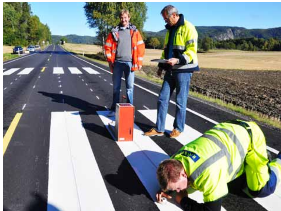
FV. 40 I LARVIK: I fjor startet test av ny vegoppmerking i Lågendalen. Forsøket følges til høsten opp med tilsvarende utprøving av gul vegoppmerking på samme strekning.
