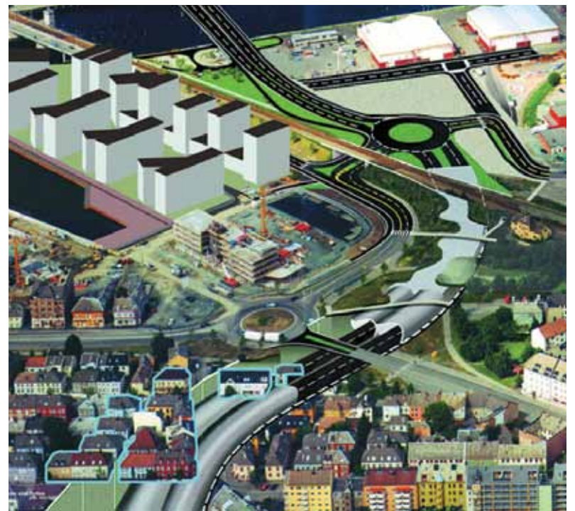
PARK KOMMER: Kvikkleireområdet går fra rundkjøringen og ned til fjellet. Når betongtunnelen er ferdig skal den fylles over og bli et parkområde. Fem hus ble løftet bort i fjor og skal løftes tilbake til der hvor de sto. (Ill: H. Klæboe, Multiconsult)
