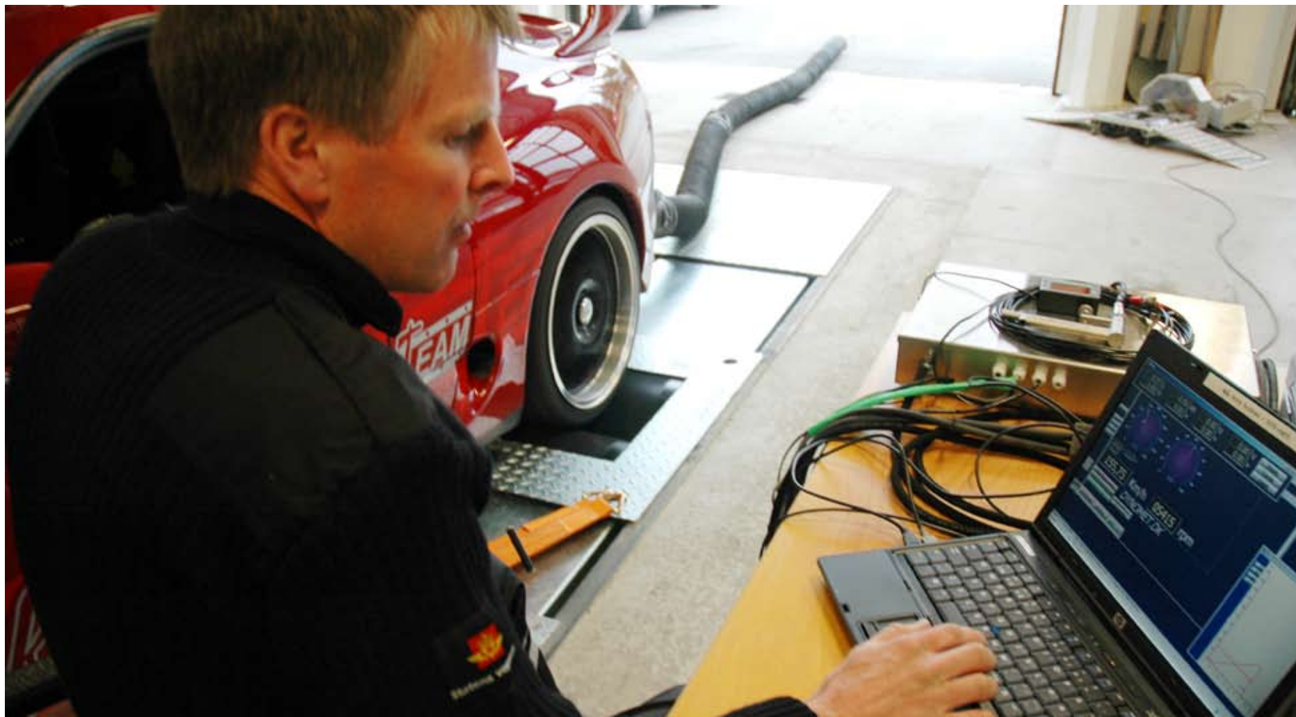
Testing: En kontrollør gjennomfører en effekttest av en motor i en sportsbil. Målet med testingen er å komme den ulovlige trimmingen til livs. (Foto: Eivind Sperre Austnes)
