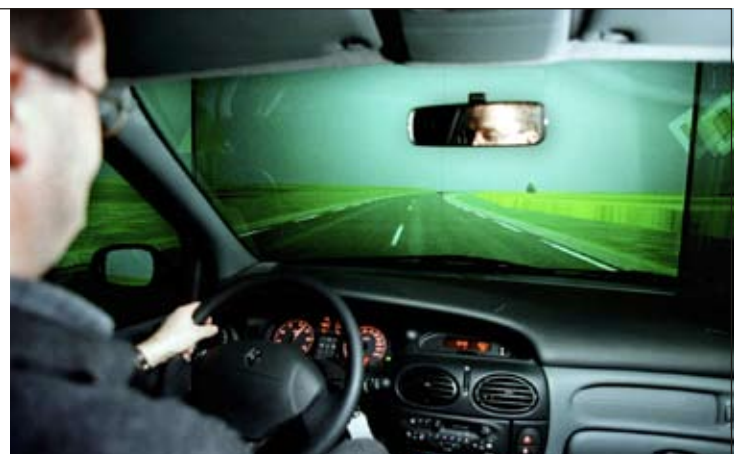
Testes: 30 forsøkspersoner skal teste elektronisk kantlinje i Sintef/NTNU sin kjøresimulator. (Arkivfoto: Rune Petter Ness, Sintef)
