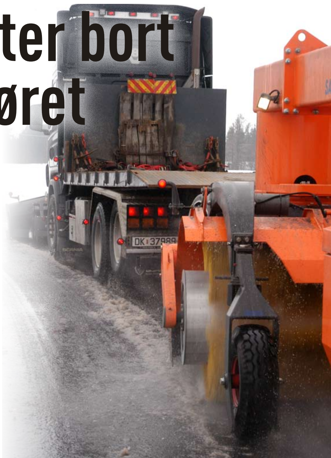
Roterende: Øvreaasens forsøksmaskin er basert på roterende børster i plast. (Foto: Håkon Aurlien)
