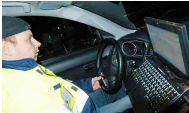
Friksjonsmåling: Ken Jøran Frivoll ute på veg med en av målebilene. Tre ganger daglig skal vegnettet dokumenteres med førerapporter.
